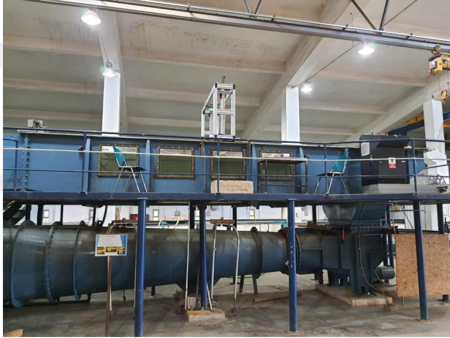
Şekil 4.1 : İstanbul Teknik Üniversitesi Gemi İnşaatı ve Deniz Bilimleri Fakültesi Ata Nutku Gemi ve Model Laboratuvarı Sirkülasyon Kanalı Akış Kaynaklı Hareketler (FIM) Laboratuvarı.
