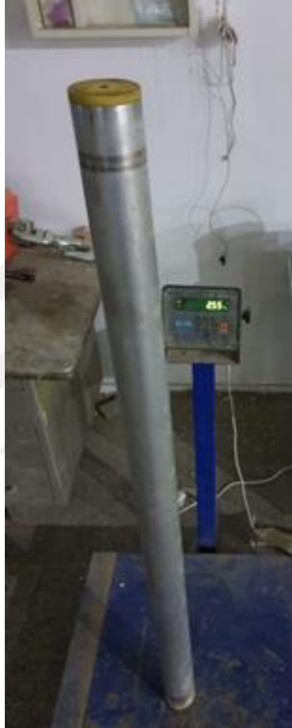
Şekil 4.5 : Deneylerde kullanılan silindirin demonte halde özellikleri ölçülürken bir baskül üzerindeki görüntüsü.
