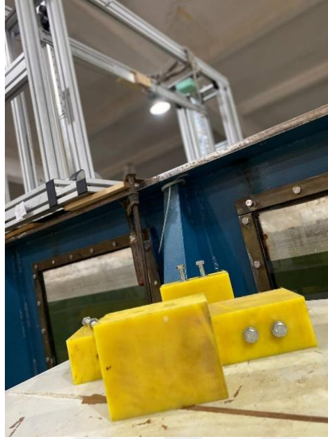
Şekil 4.7 : Silindirin serbest su yüzeyine daha çok yaklaşması için kullanılan ara parçalar ve bu parçaların vidaları (de-monte halde).
