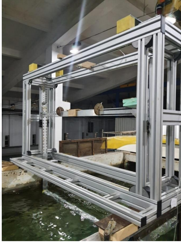
Şekil 4.6 : Destek çubuğuna harici ekstra eklenmiş ağırlıklar.
