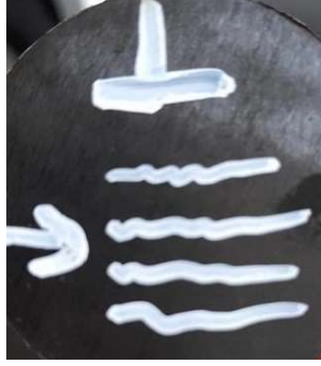
Şekil 3.8 : “1” nolu blok üzerinden alınan ilk numunenin takım yoluna paralel yönde incelenmesi.
