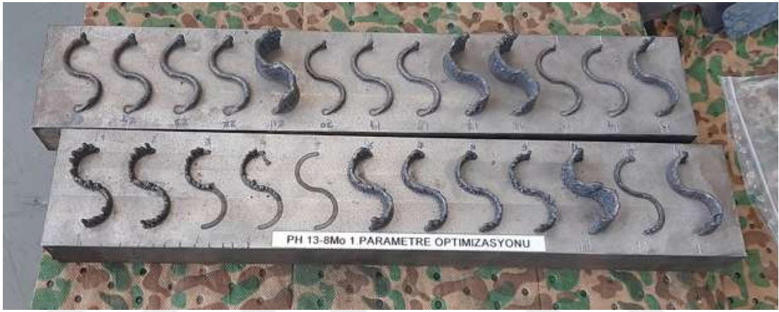
Şekil 2.3 : S-şekilli numunelerin eldesi.
