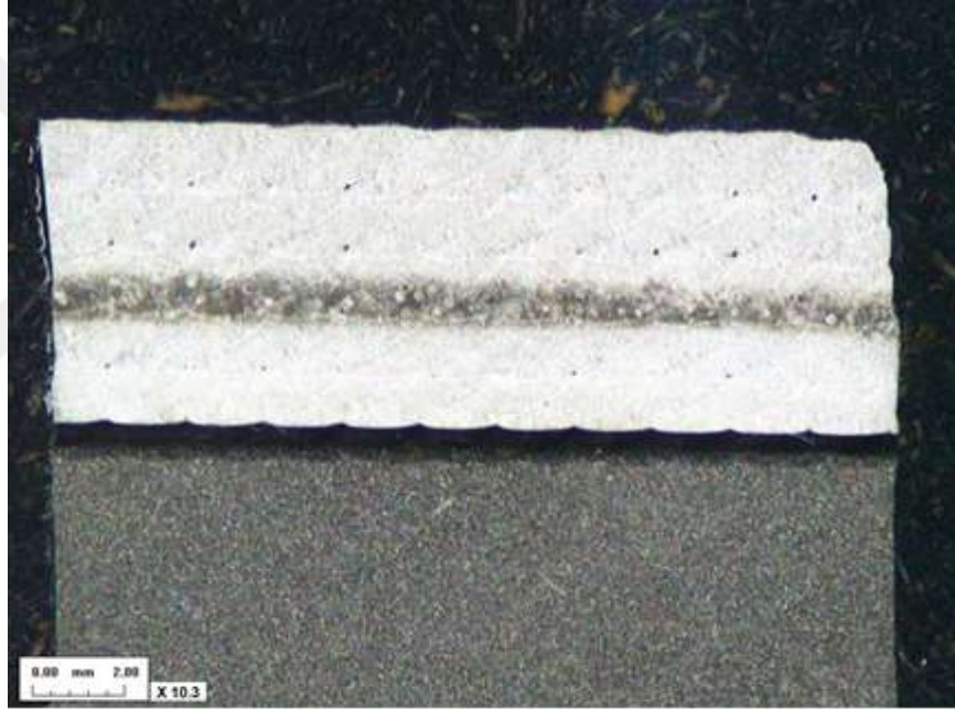
Şekil 3.9 : “1” nolu blok üzerinden alınan ilk numunenin takım yoluna paralel yönde makro görünüşü.
