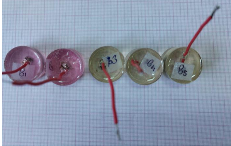
Şekil 4.4. Korozyon testi için bakalit içine gömülü lehimlenmiş alaşımlar
