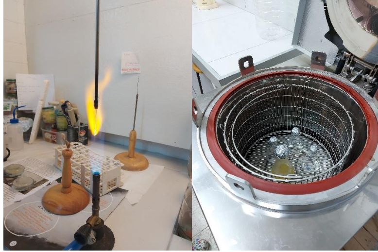
Şekil 4.6. Alevden geçirme ile otoklavda sterilizasyon yöntemi
