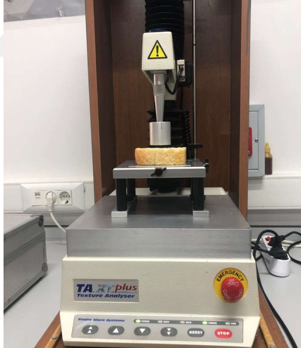
Şekil 6. Tekstür analizi için kullanılan SMS (Stable Micro System, model TA XT.plus, England) analiz cihazı
