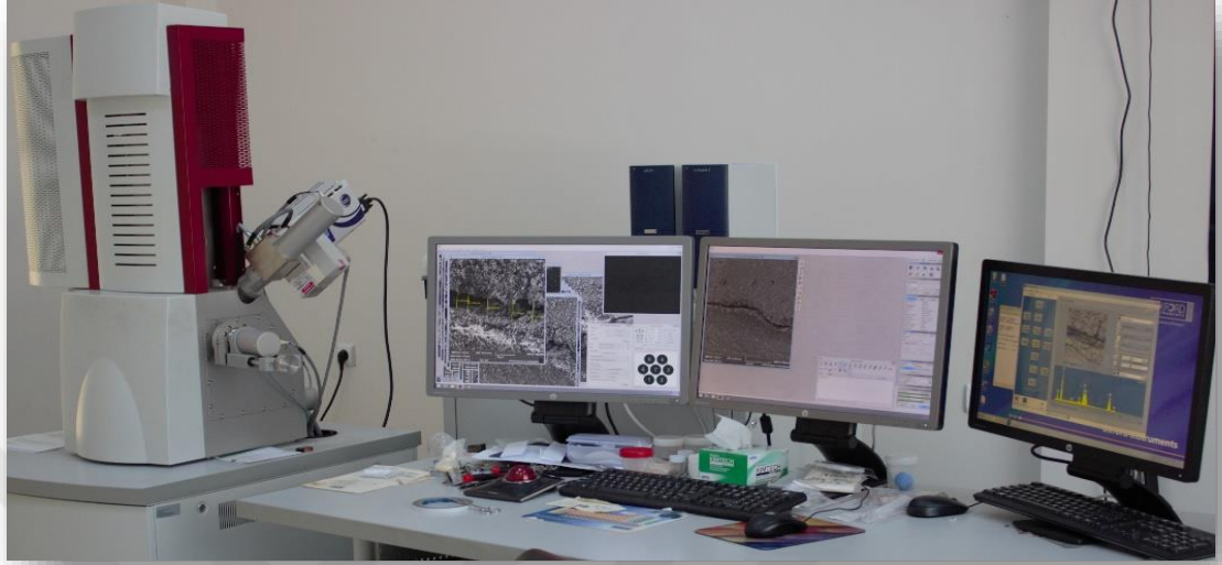
Şekil 3.24. Kırık tiplerinin incelendiği SEM cihazı (Tescan MIRA3, Çek Cumhuriyeti)
