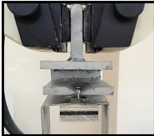
Şekil 4.11. Grupların vida tutma direnci testi esnasındaki görüntüleri
