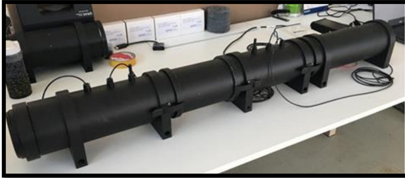
Şekil 3.26. Akustik özelliklerin belirlenmesinde kullanılan empedans tüpü (Büyük tüp)
