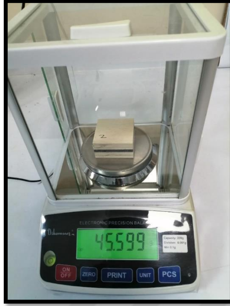
Şekil 3.16. Fiziksel özelliklerin belirlenmesinde kullanılan hassas terazi
