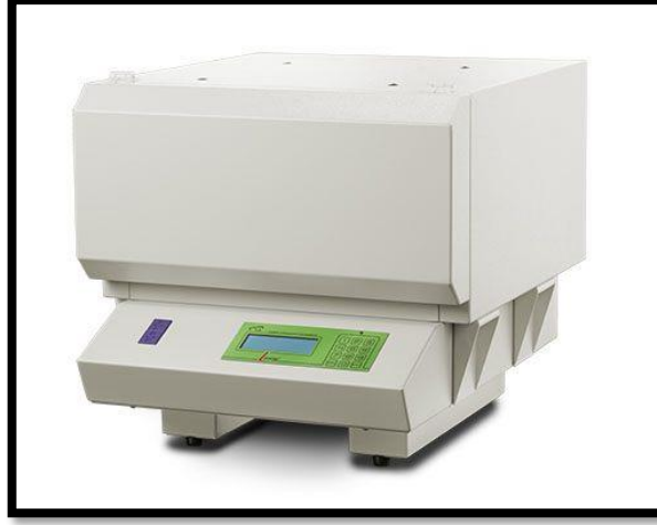
Şekil 3.22. Isı iletkenlik katsayısı ve ısı geçirgenlik katsayısı ölçüm cihazı (URL-10)
