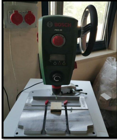
Şekil 3.20. Test örneklerine pilot deliği açma işlemi
