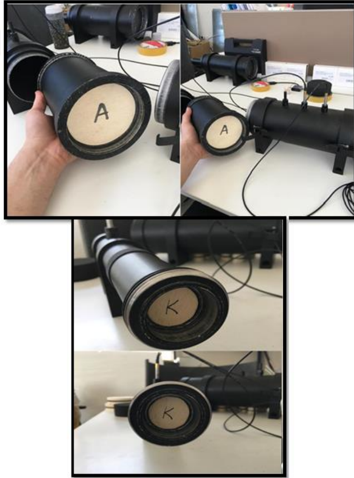
Şekil 3.28. Test örneklerinin empedans tüpüne montajı
