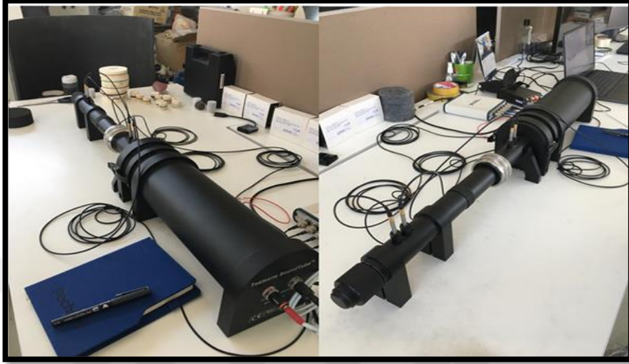
Şekil 3.25. Akustik özelliklerin belirlenmesinde kullanılan empedans tüpü (Küçük tüp)
