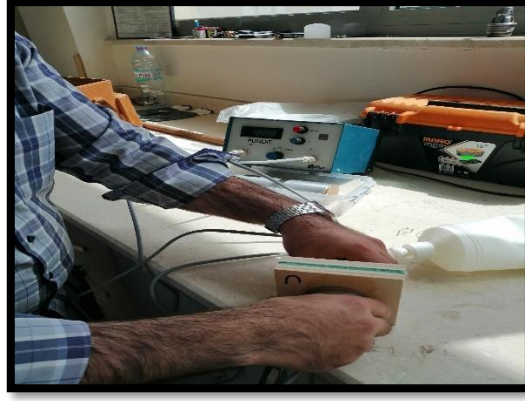
Şekil 4.19. Ultrasonik ses iletim hızı testinin yapılışı
