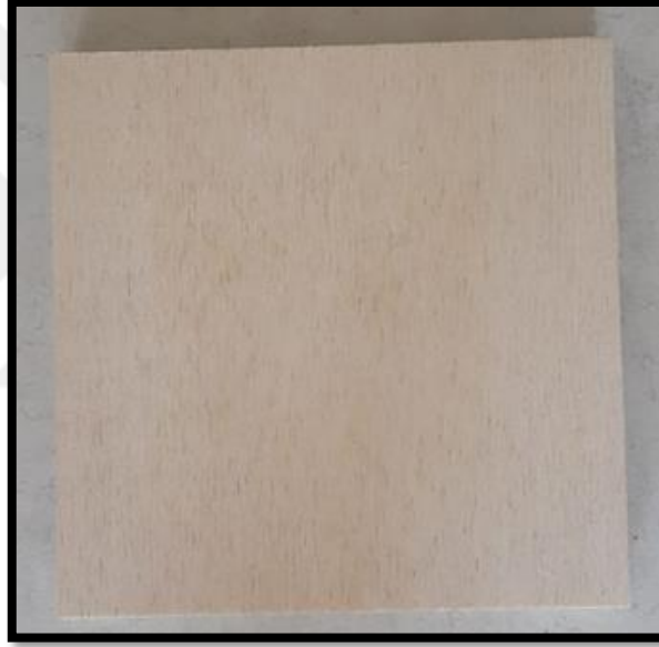
Şekil 3.23. Isı iletkenlik katsayısı ve ısı geçirgenlik katsayısı ölçümünde kullanılan test örneği
