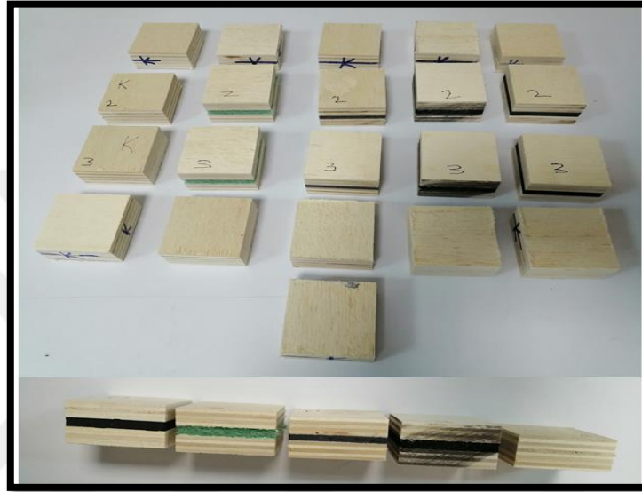
Şekil 3.15. Fiziksel özelliklerin belirlenmesi için kullanılan test örnekleri
