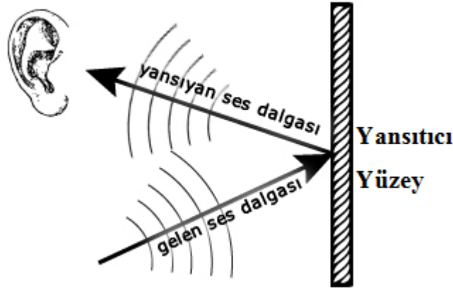
Şekil 1.5. Yansıtıcı yüzeyin ses dalgalarını yansıtması (URL-5)
