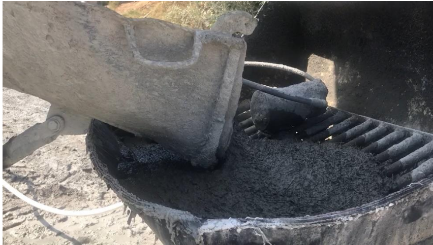
Şekil 4.8 : Püskürtme beton makinesi mazgal yapısı.
