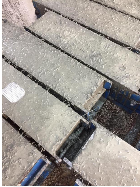
Şekil 2.15 : Fiberli betonların numune kalıplarına alınması.
