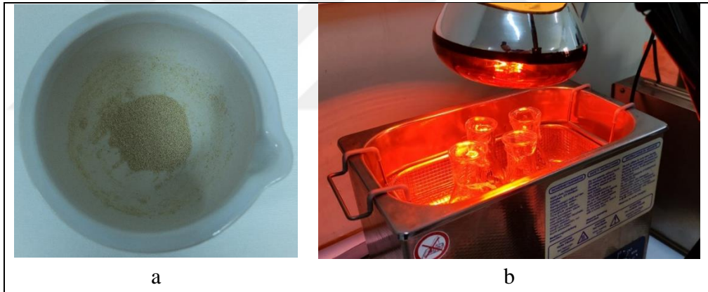
Şekil 3.5. Toz haline getirilmiş kökler (a), ultrasonik banyo ve infrared ışık altında gerçekleştirilen ekstraksiyon işlemi (b)
