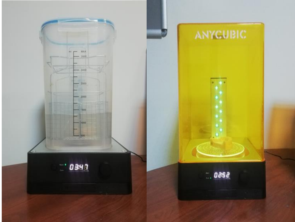
Şekil 3.11. a,b Bir baskı modeline, izopropil alkol ile yıkama işlemi yapılması, yıkama işlemi sonrasında kürlleme işlemi uygulanması
