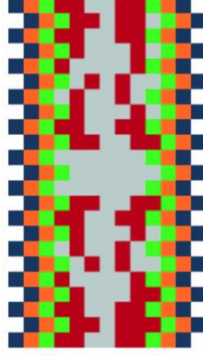
Şekil 4.7.70. Kolan Dokumanın Örgü Raporu (E.Demirbaş, 2022)
