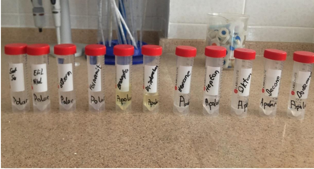
Şekil 3.2 Çalışmada kullanılan polar/apolar ölçüm sıvılarının ölçüm öncesi falcon deney tüplerindeki görünümü.
