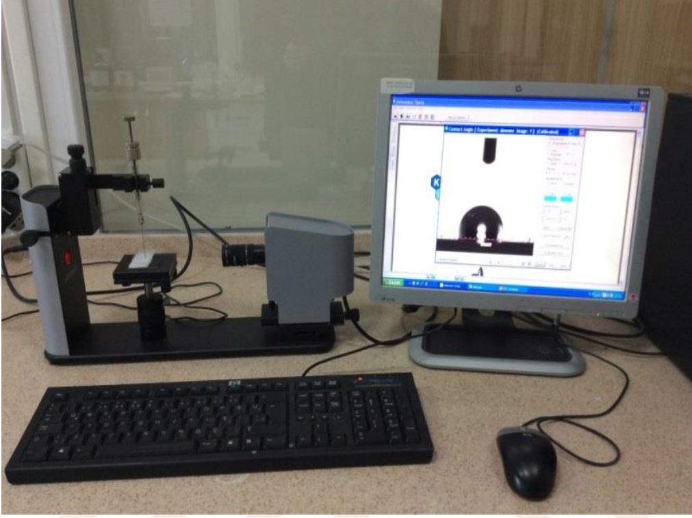
Şekil 3.12 Çalışmalarda kullanılan temas açısı ölçümü (ve buna dayalı serbest yüzey enerjisi hesaplama) cihazı (KSV Attension ThetaLite TL 101 Optical Tensiometer).
