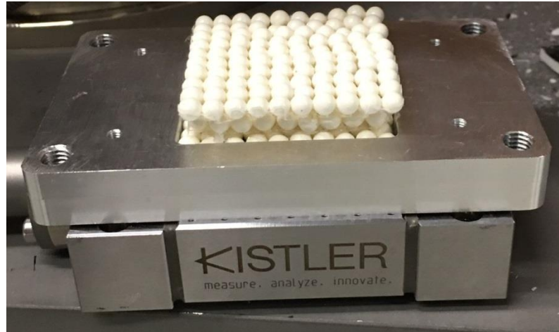
Şekil 5.5 Numunenin Dinamometreye Montajı
