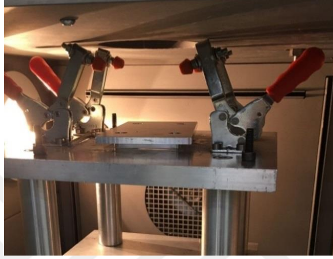
Şekil 5.4 Fikstür Üzerine Numunenin Yerleşimi
