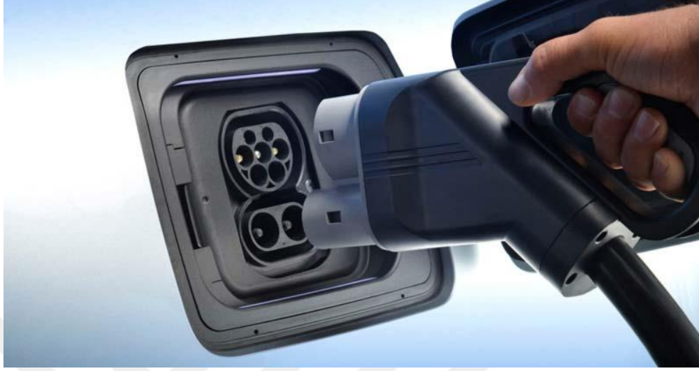
Şekil 3.6 : Mod 3 + mod 4 CCS Soketi yapısı.
