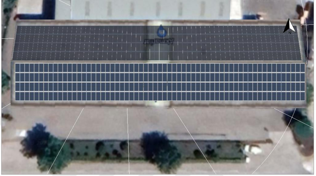
Şekil 6.5 : OPENSOLAR programı ile tasarlanan tam ölçekli panel yerleşim modeli.
