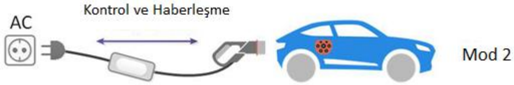
Şekil 3.2 : Standart prizden kablo üzerinde yer alan sınırlı iletişim veya güvenlik bağlantısı ile şarj.
