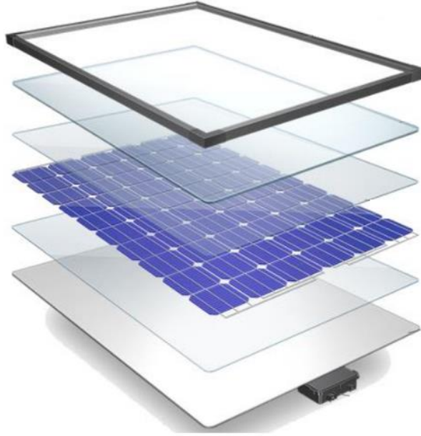
Şekil 5.1 : Güneş paneli iç yapısı katmanları.
