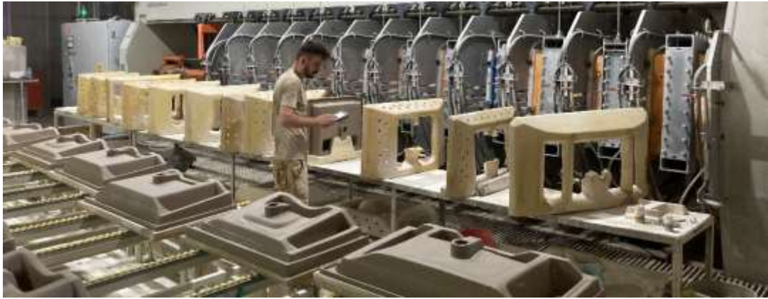
Şekil 2.35 : Basınçlı döküm sistem, lavabo üretim tezgâhı.
