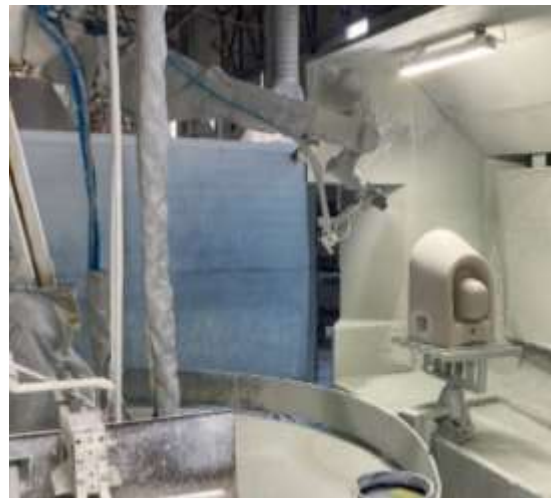
Şekil 2.37 : Klozet iç alan sırlama aşaması ve robotik sırlama.
