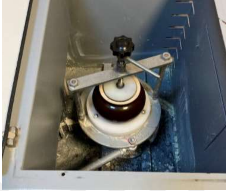
Şekil 3.4 : Sarsak jet değirmende öğütme aşaması.
