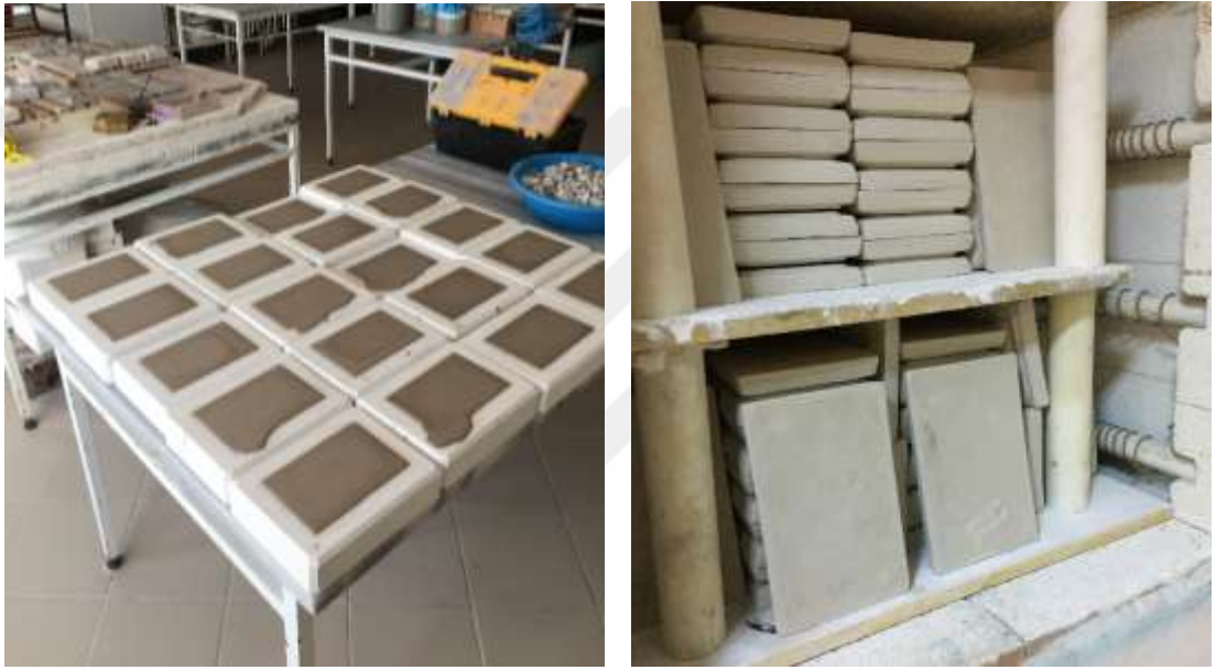
Şekil 3.2 : Plakaların şekillendirme ve ön kurutma aşamaları.
