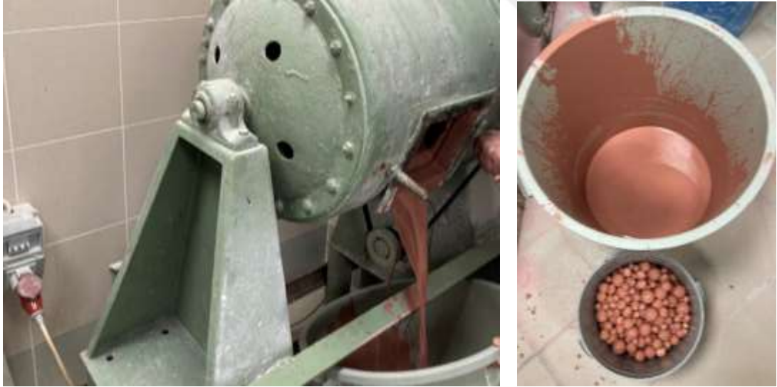
Şekil 4.3 : Öğütme işlemi tamamlanmış sırların boşaltılması.
