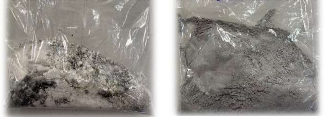
Şekil 3.3 : Kuru tartımı yapılmış hammaddelerin harmanlanması.
