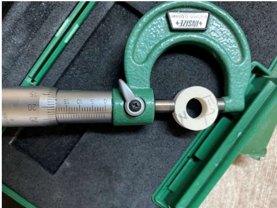
Şekil 3.9 : Mikrometre ile buller halkası ölçümü.
