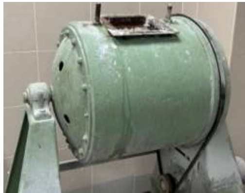
Şekil 4.1 : Kullanılan değirmen ve alümina bilyeler.
