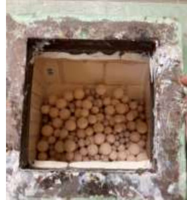
Şekil 4.1 : Kullanılan değirmen ve alümina bilyeler.
