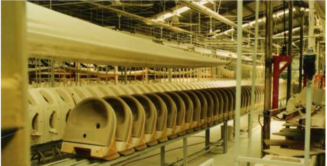
Şekil 2.34 : Batarya döküm sistemi, lavabo üretim tezgâhı.
