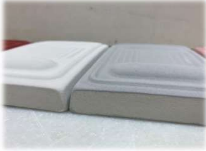
Şekil 3.5 : Sır uygulama öncesi, sır kalınlık kontrolü.
