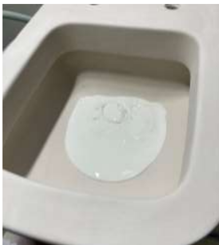
Şekil 2.37 : Klozet iç alan sırlama aşaması ve robotik sırlama.
