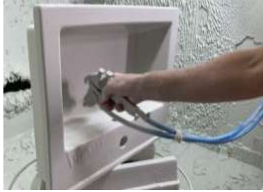
Şekil 2.36 : Manuel püskürtme yöntemi ile lavabo sırlama aşaması.
