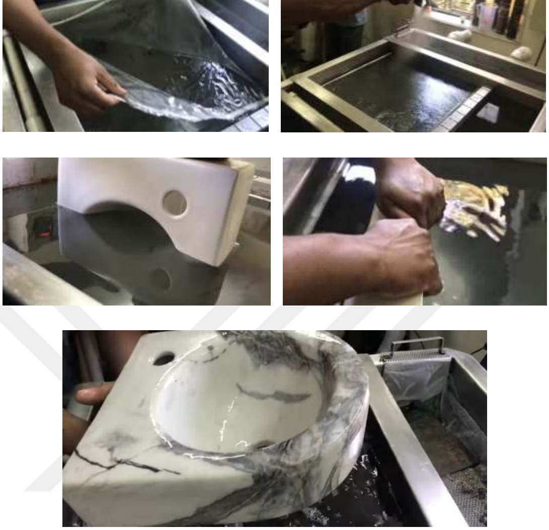
Şekil 2.39 : Hidrografik transfer aşamaları.
