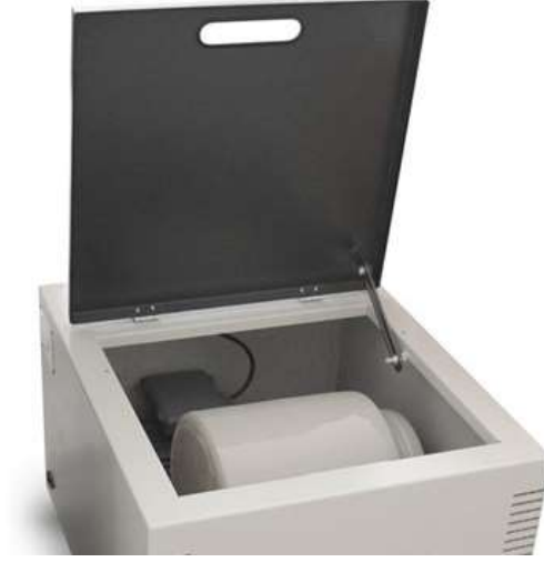
Şekil 4. 4 : Laboratuvar tipi deneme değirmeni.
