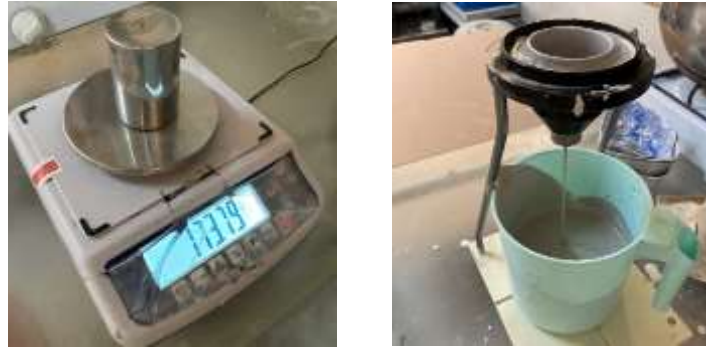
Şekil 4.6 : Yoğunluk ve akış kontrolü.
