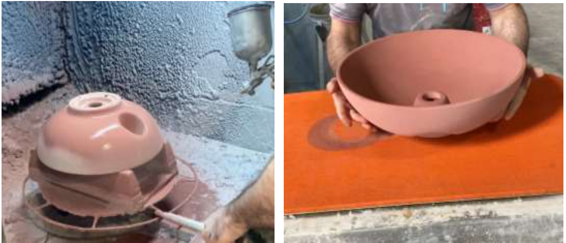
Şekil 4.8 : Sır uygulama ve dip silme aşamaları.
