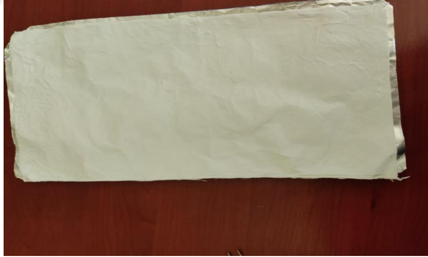
Şekil 3.11: Elektrosinle üretilmiş, alimünyum folya üzerinde PCL nanofiber membranı.
