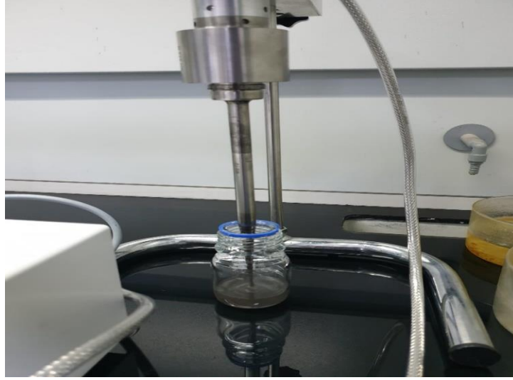
Şekil 3.7: Gümüş nanoparçacıkların DMF ve kloroform içerisinde ultrasonik karıştırıcı ile dağıtılması.
