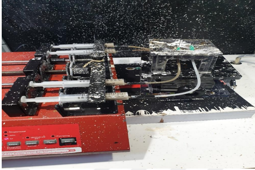
Şekil 3.10: Elektrosin sırasında enjektör pompası, enjektör ve iğne uçlarının pozisyonu.
