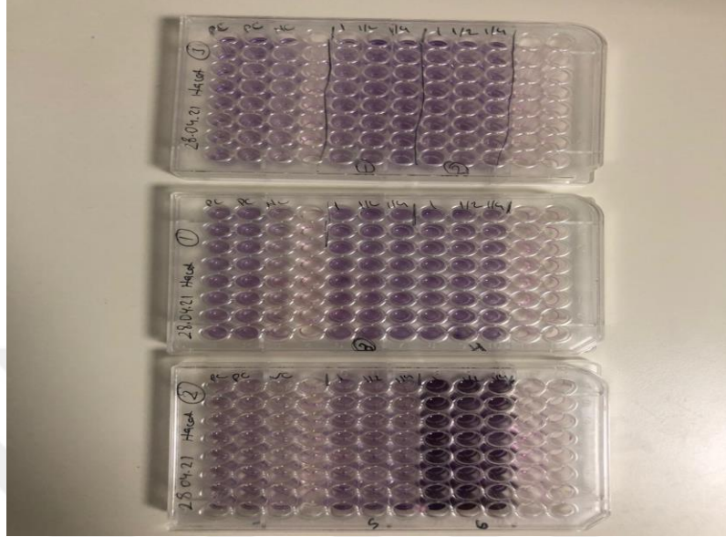
Şekil 3.18: MTT solüsyonu ve HaCaT hücre kültürü içeren, 8 tekrarla hazırlanan ve sağa doğru seri seyreltme ile numune solüsyonu eklenmiş 96’lık kuyu plakaları.
