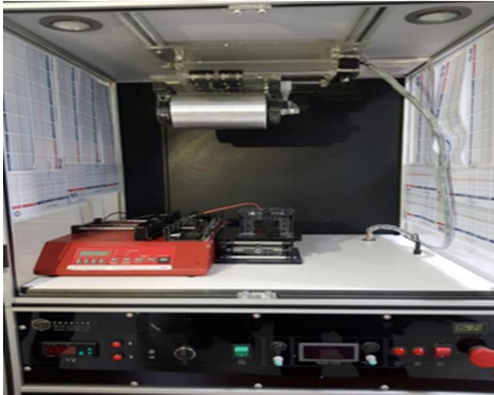
Şekil 3.9: Nanofiberlerin üretildiği elektrospın cihazı.
