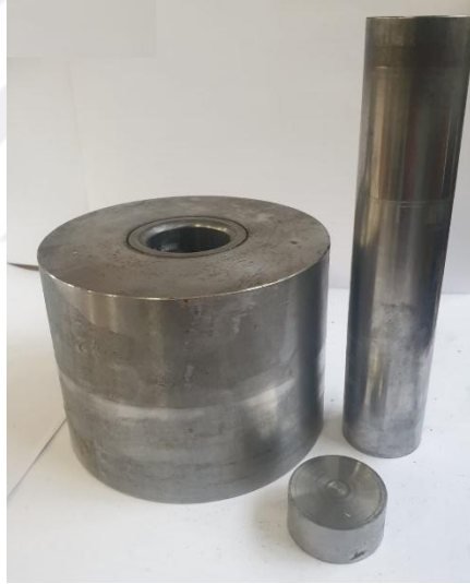
Şekil 6.1. Numune üretiminde kullanılan kalıp ve üretilen numune.
