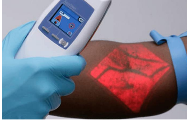
Resim 28. Accuvein Firmasının Damarları Gösteren Cihazı
