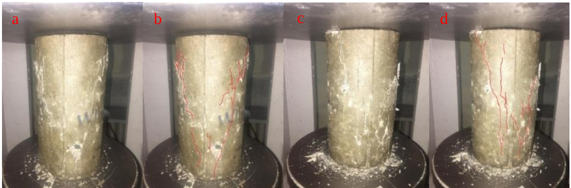
Şekil 63. WII-C-1 (a ve b) ve WII-C-2 (c ve d) numunelerine ait kırılma şekli.
