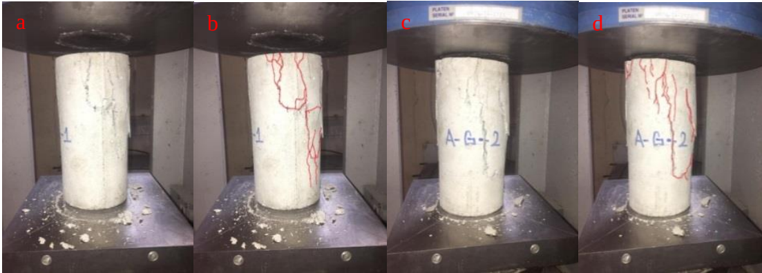
Şekil 41. A-G-1 (a ve b) ve A-G-2 (c ve d) numunelerine ait kırılma şekli.
