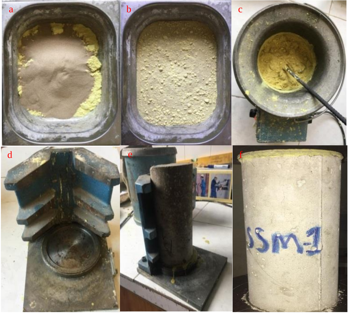
Şekil 22. Kükürt + silis kumu yöntemi ile başlıklamaya ait fotoğraflar.
