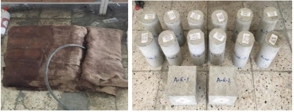
Şekil 15. Hava kürü (a:3 günlük nem kürü, b:laborauvar ortamı).
