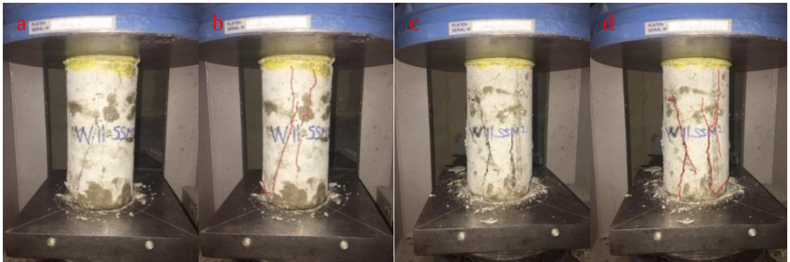
Şekil 66. WII-SSM-1 (a ve b) ve WII-SSM-2 (c ve d) numunelerine ait kırılma şekli.
