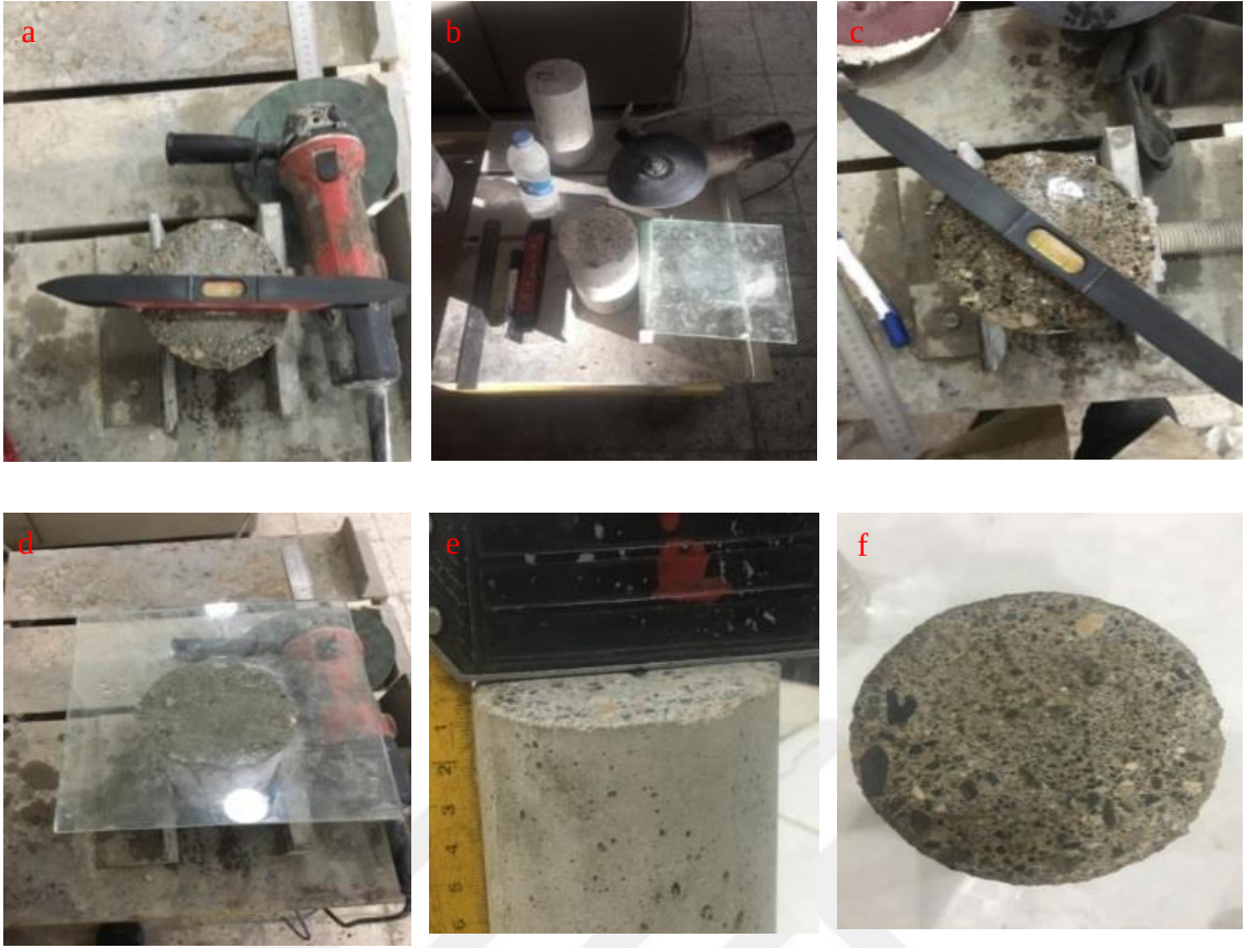
Şekil 19. Manuel öğütme yöntemine ait fotoğraflar.
