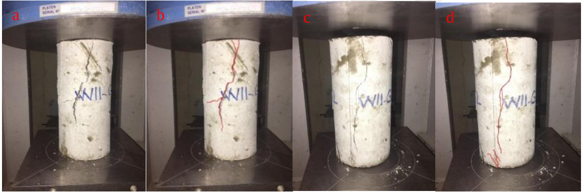
Şekil 62. WII-G-1 (a ve b) ve WII-G-2 (c ve d) numunelerine ait kırılma şekli.
