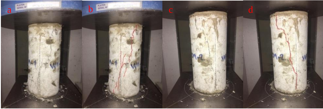
Şekil 67. WII-CM-1 (a ve b) ve WII-CM-2 (c ve d) numunelerine ait kırılma şekli.
