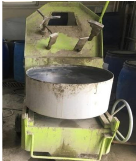
Şekil 12. Beton üretiminde kullanılan mikser.
