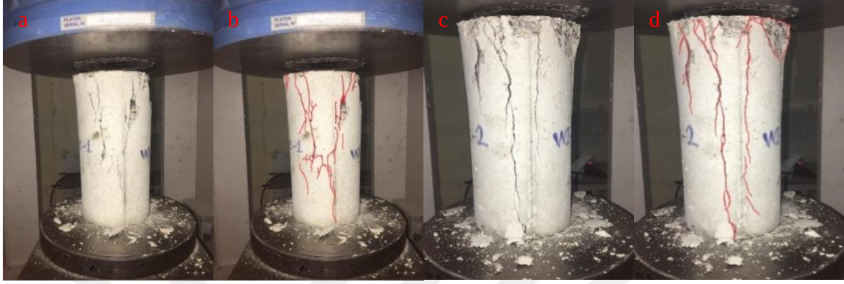
Şekil 54. WI-WC-1 (a ve b) ve WI-WC-2 (c ve d) numunelerine ait kırılma şekli.
