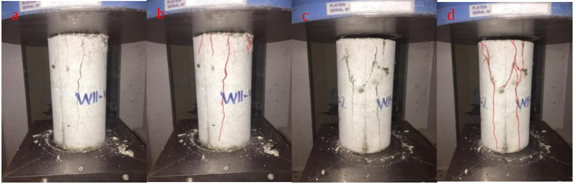
Şekil 61. WII-WC-1 (a ve b) ve WII-WC-2 (c ve d) numunelerine ait kırılma şekli.
