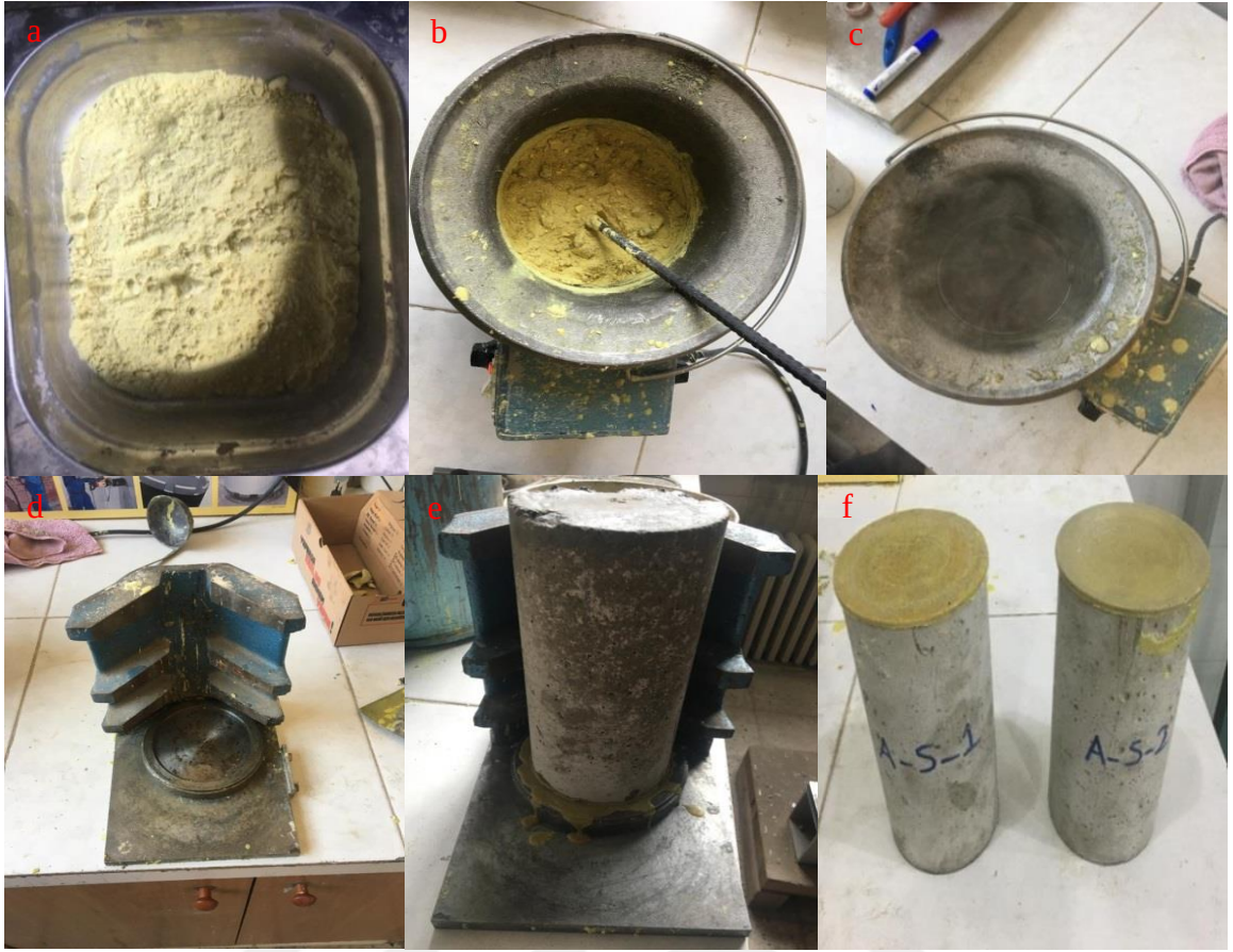
Şekil 21. Kükürt yöntemi ile başlıklamaya ait fotoğraflar.
