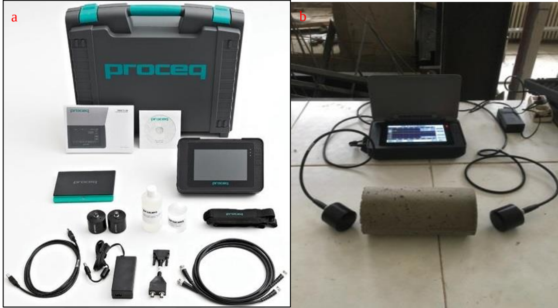
Şekil 25. UPV cihazına ait fotoğraflar (a: üretici firmadan alınan, b:deney esnasından alınan)
