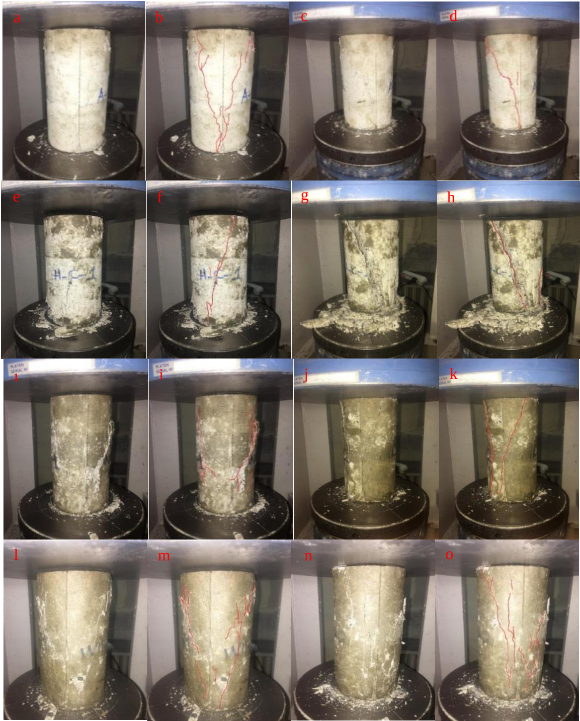
Şekil 71. A-C-1 (a ve b), A-C-2 (c ve d), H-C-1 (e ve f), H-C-2 (g ve h), WI-C-1 (ı ve i), WI-C-2 (j ve k), WII-C-1 (l ve m) ve WII-C-2 (n ve o) numunelerine ait kırılma şekilleri.
