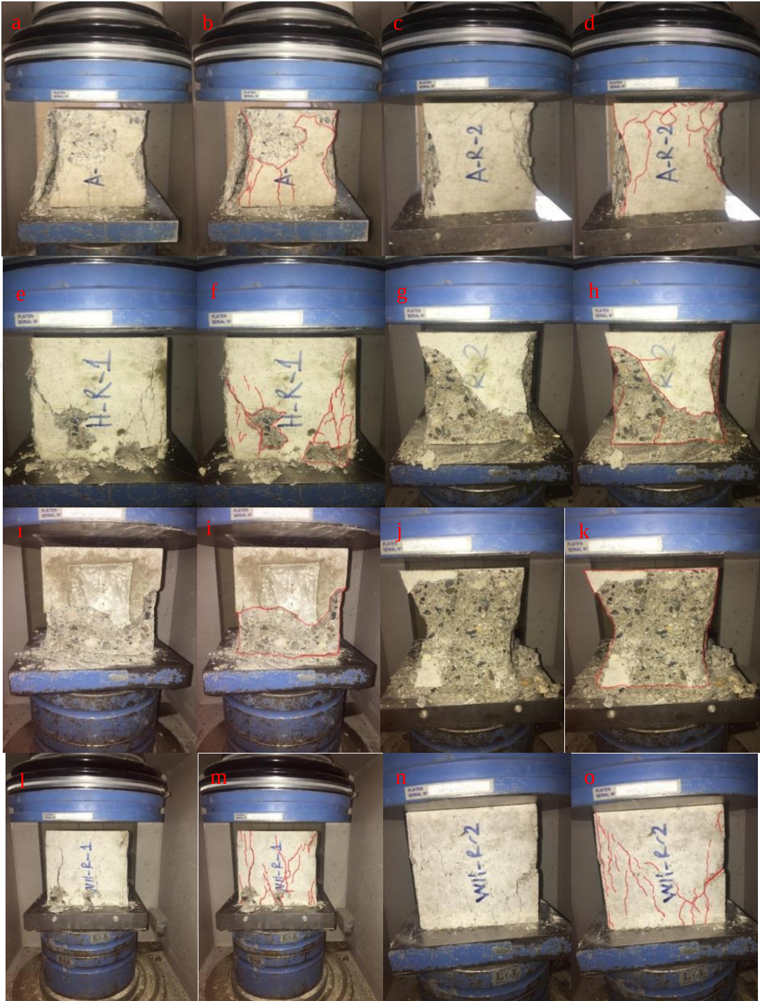
Şekil 68. A-R-1 (a ve b), A-R-2 (c ve d), H-R-1 (e ve f), H-R-2 (g ve h), WI-R-1 (ı ve i), WI-R-2 (j ve k), WII-R-1 (l ve m) ve WII-R-2 (n ve o) numunelerine ait kırılma şekilleri (Aynı kodlu numunelerden sağdaki, soldakinin çatlaklarının kalemle belirginleştirilmiş halidir).
