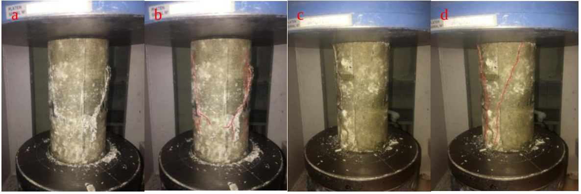
Şekil 56. WI-C-1 (a ve b) ve WI-C-2 (c ve d) numunelerine ait kırılma şekli.
