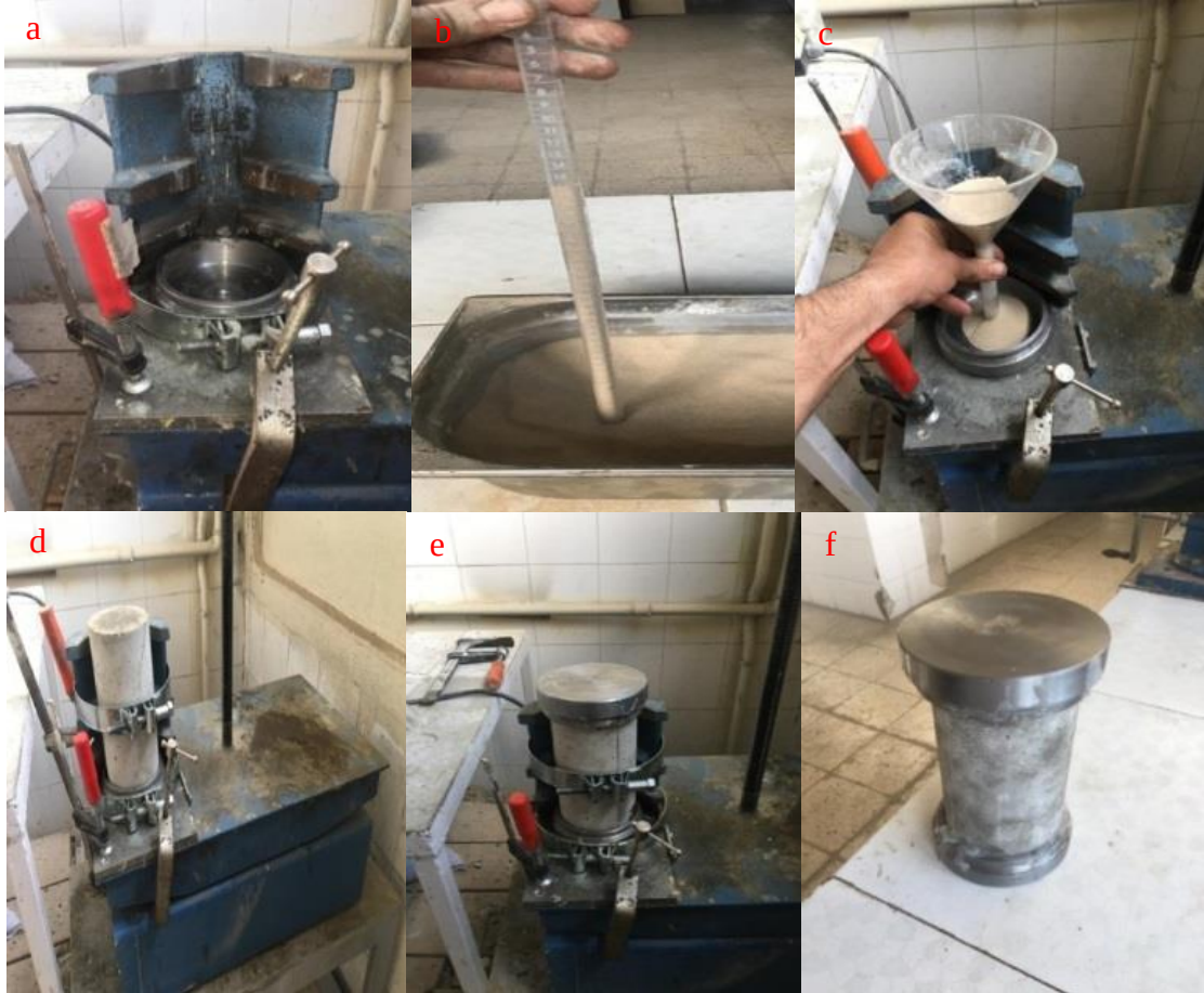
Şekil 23. Kum kutusu ile başlıklama yöntemine ait fotoğraflar.
