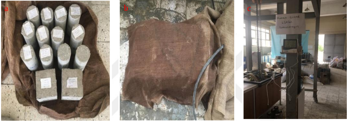
Şekil 16. Nem kürü (a ve b: ıslak telis bezi içindeki örnekler, c: sıcaklık ve nem ölçümü).
