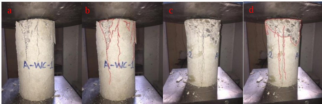
Şekil 40. A-WC-1 (a ve b) ve A-WC-2 (c ve d) numunelerine ait kırılma şekli.
