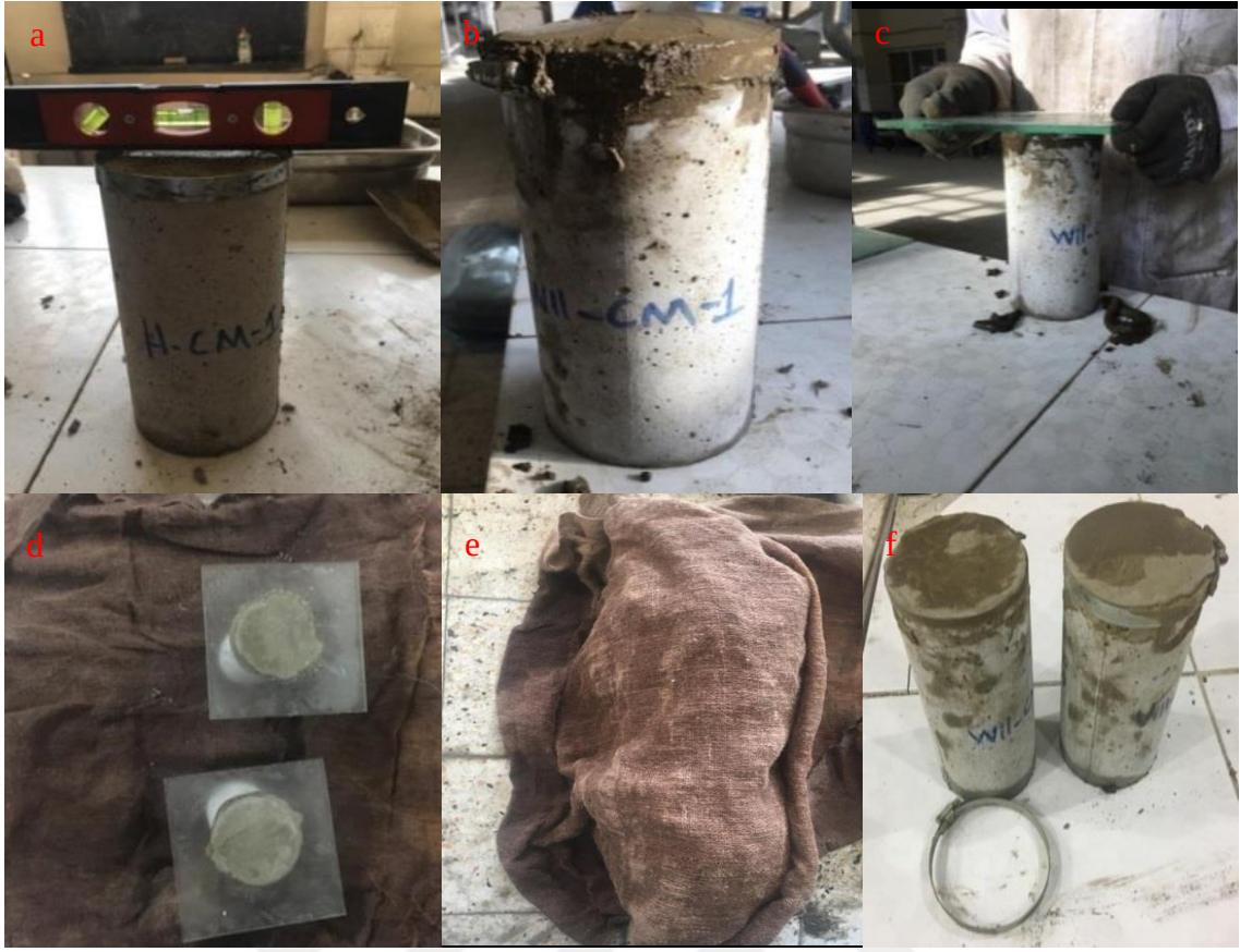
Şekil 24. Kalsiyum Alüminat Çimentosu yöntemi ile başlıklamaya ait fotoğraflar.
