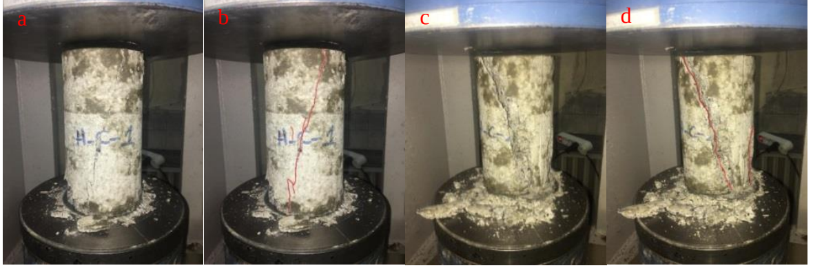
Şekil 49. H-C-1 (a ve b) ve H-C-2 (c ve d) numunelerine ait kırılma şekli.
