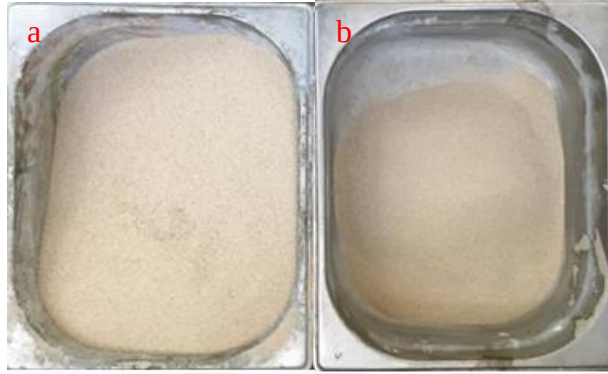
Şekil 9. Silis kumu (a: elenmemiş, b: 250 µm elekten geçen 125 µm elek üzerinde kalan).
