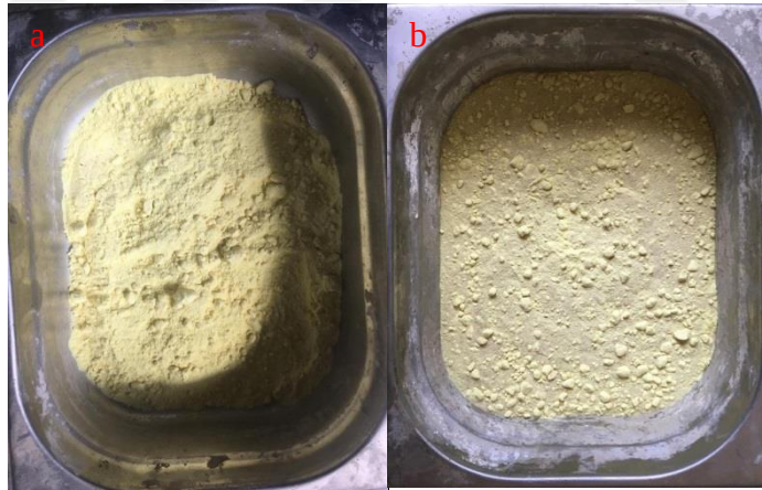
Şekil 10. Kükürt ve kükürtlü karışım (a: Kükürt ve b: Kükürt + Silis Kumu).
