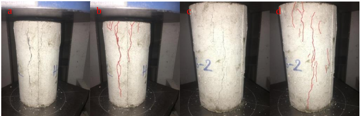
Şekil 48. H-G-1 (a ve b) ve H-G-2 (c ve d) numunelerine ait kırılma şekli.
