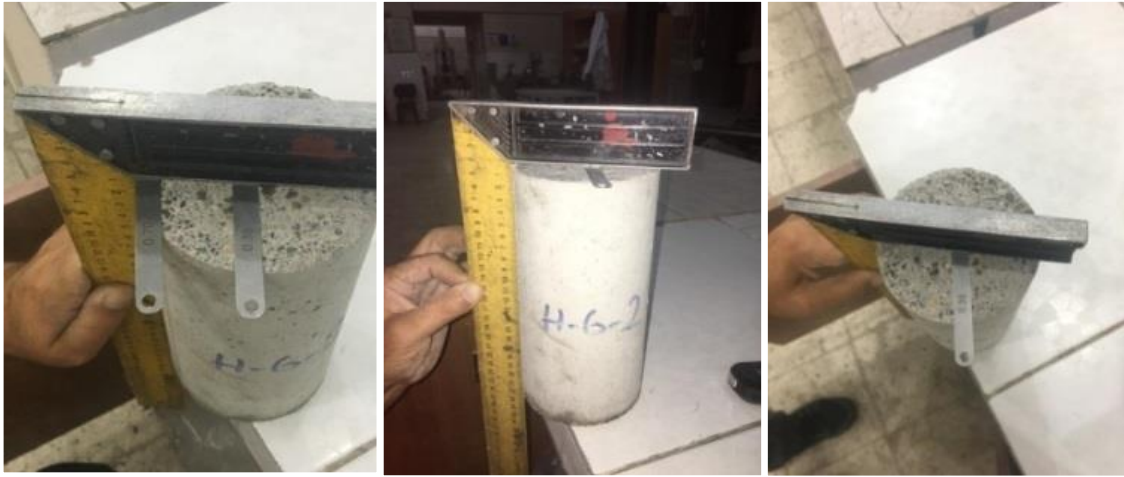
Şekil 31. Manuel öğütme yöntemi ile başlıklamada düzlük kontrolü.
