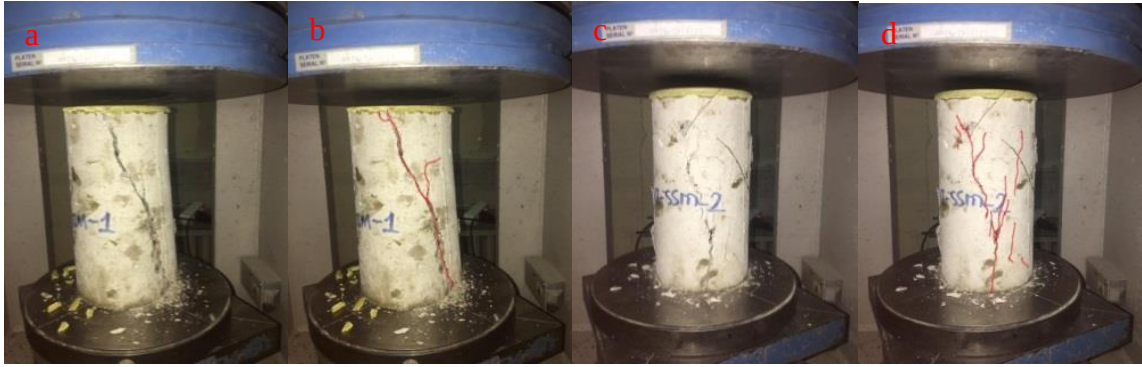
Şekil 1. WI-SSM-1 (a ve b) ve WI-SSM-2 (c ve d) numunelerine ait kırılma şekli.
