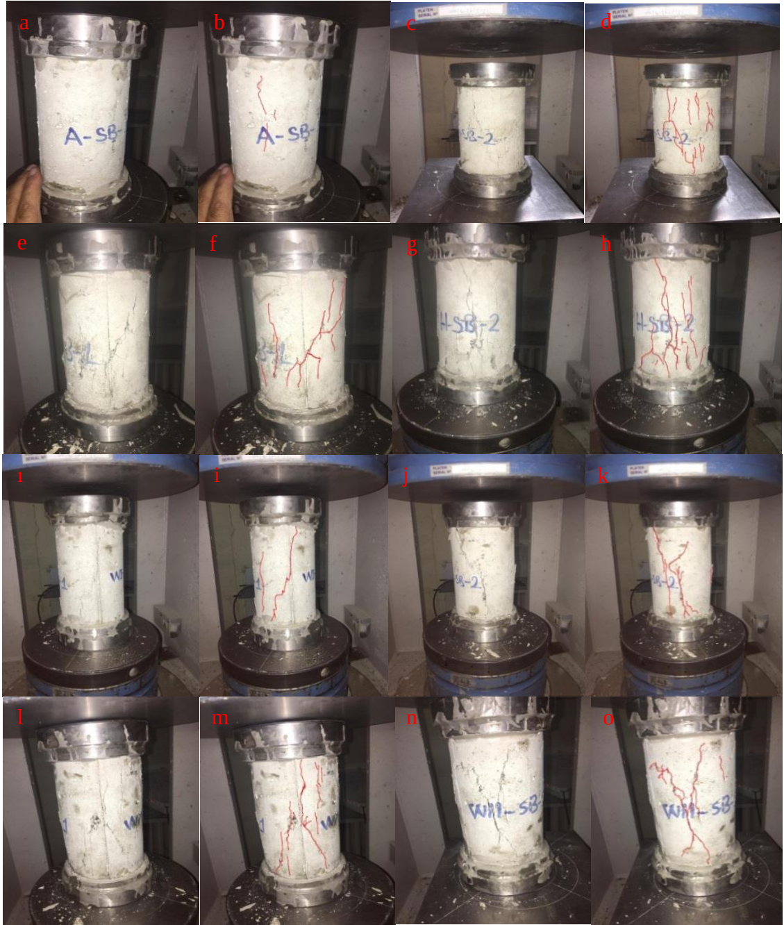
Şekil 72. A-SB-1 (a ve b), A-SB-2 (c ve d), H-SB-1 (e ve f), H-SB-2 (g ve h), WI-SB-1 (ı ve i), WI-SB-2 (j ve k), WII-SB-1 (l ve m) ve WII-SB-2 (n ve o) numunelerine ait kırılma şekilleri.
