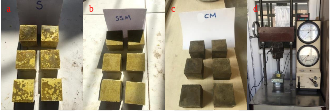
Şekil 27. Başlık malzemelerinin basınç dayanımlarının belirlenmesi için üretilen numuneler ve pres (a: kükürt, b: kükürt + silis kumu, c: kalsiyum alüminatlı çimento harcı, d: deformasyon kontrollü pres)
