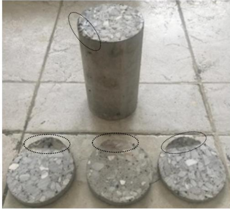
Şekil 32. Testere ile kesim sonucu numuneden parça kopması.
