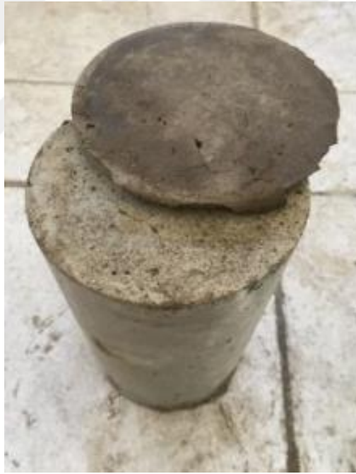
Şekil 33. Kalsiyum alüminatlı çimento başlığının numuneden ayrılması.
