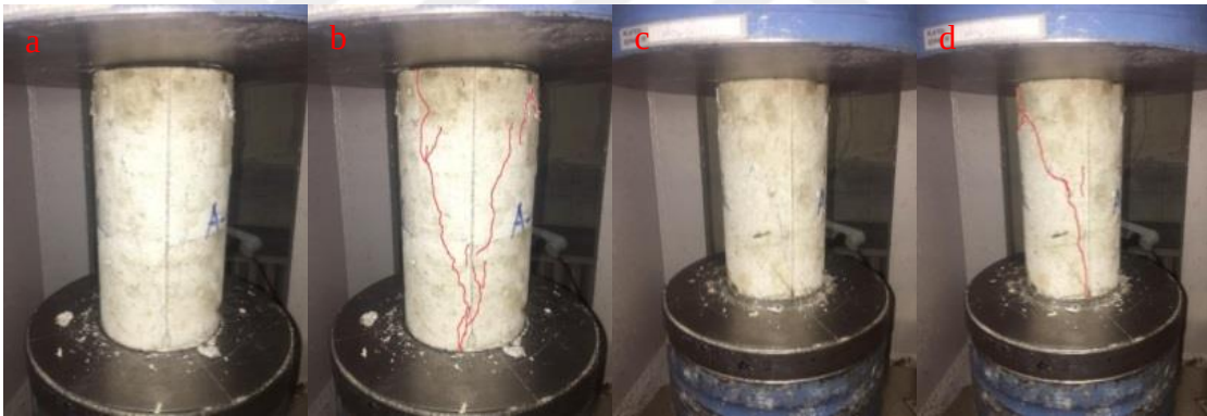
Şekil 42. A-C-1 (a ve b) ve A-C-2 (c ve d) numunelerine ait kırılma şekli.
