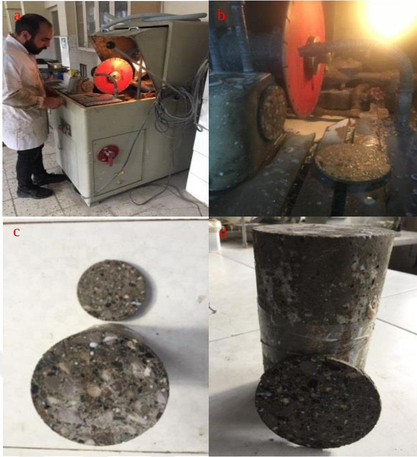
Şekil 20. Elmas testere ile kesme yöntemine ait fotoğraflar.
