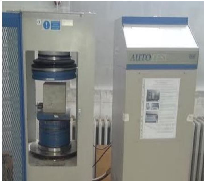
Şekil 26. Beton presine ait fotoğraf
