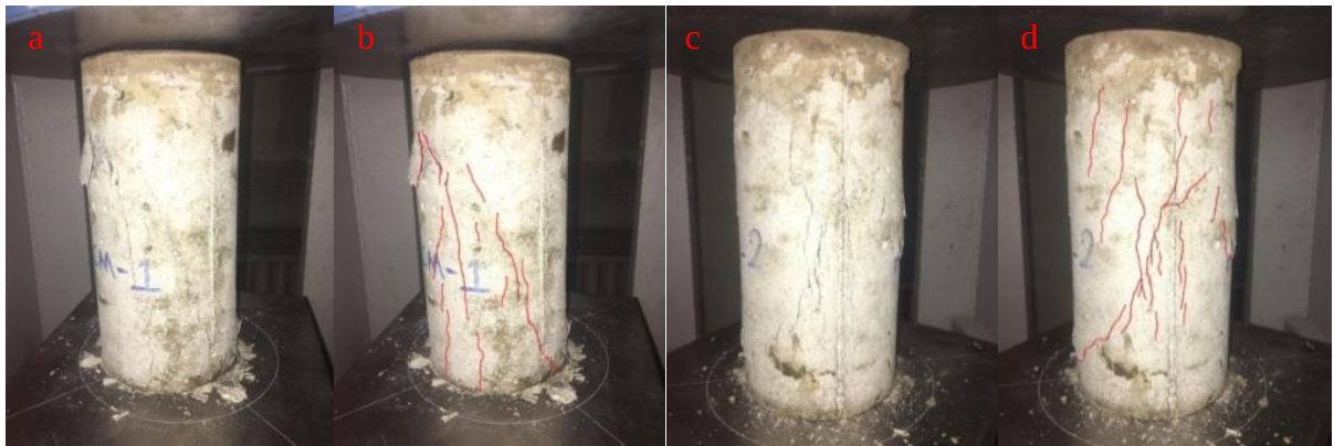
Şekil 53. H-CM-1 (a ve b) ve H-CM-2(c ve d) numunelerine ait kırılma şekli.
