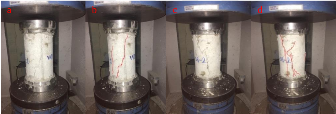
Şekil 57. WI-SB-1 (a ve b) ve WI-SB-2 (c ve d) numunelerine ait kırılma şekli.
