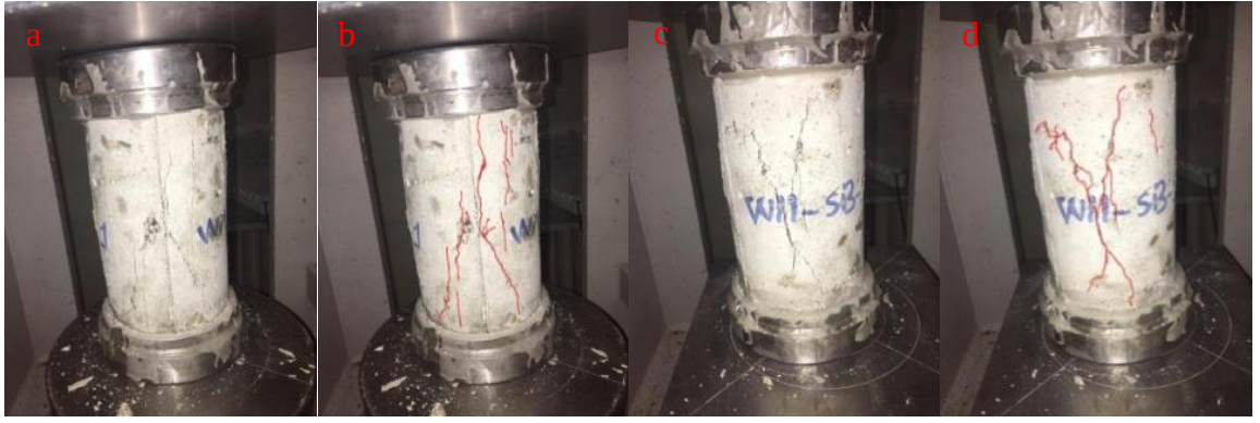
Şekil 64. WII-SB-1 (a ve b) ve WII-SB-2 (c ve d) numunelerine ait kırılma şekli.
