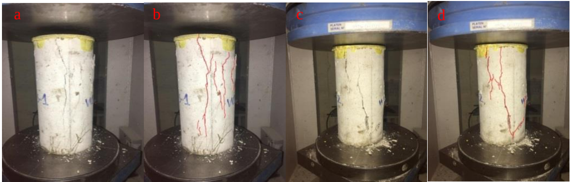
Şekil 58. WI-S-1 (a ve b) ve WI-S-2 (c ve d) numunelerine ait kırılma şekli.
