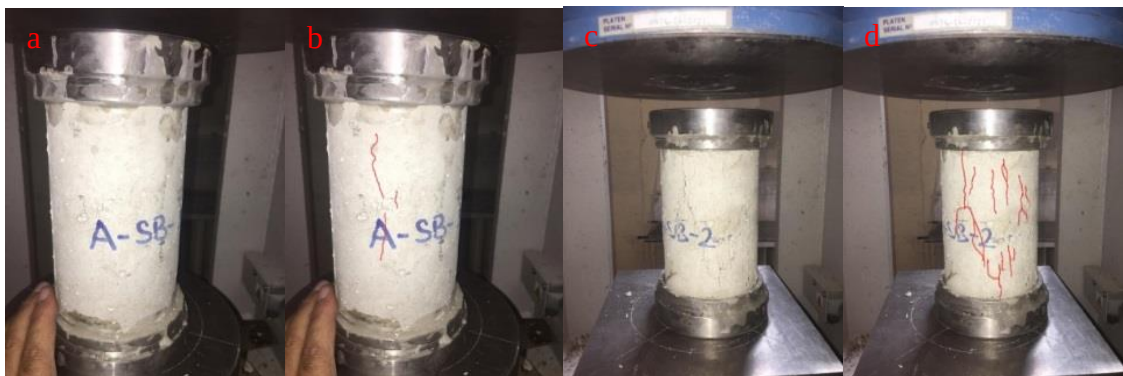
Şekil 43. A-SB-1 (a ve b) ve A-SB-2 (c ve d) numunelerine ait kırılma şekli.
