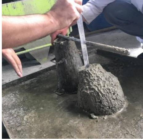
Şekil 13. Taze betonda çökme miktarı ölçümü.
