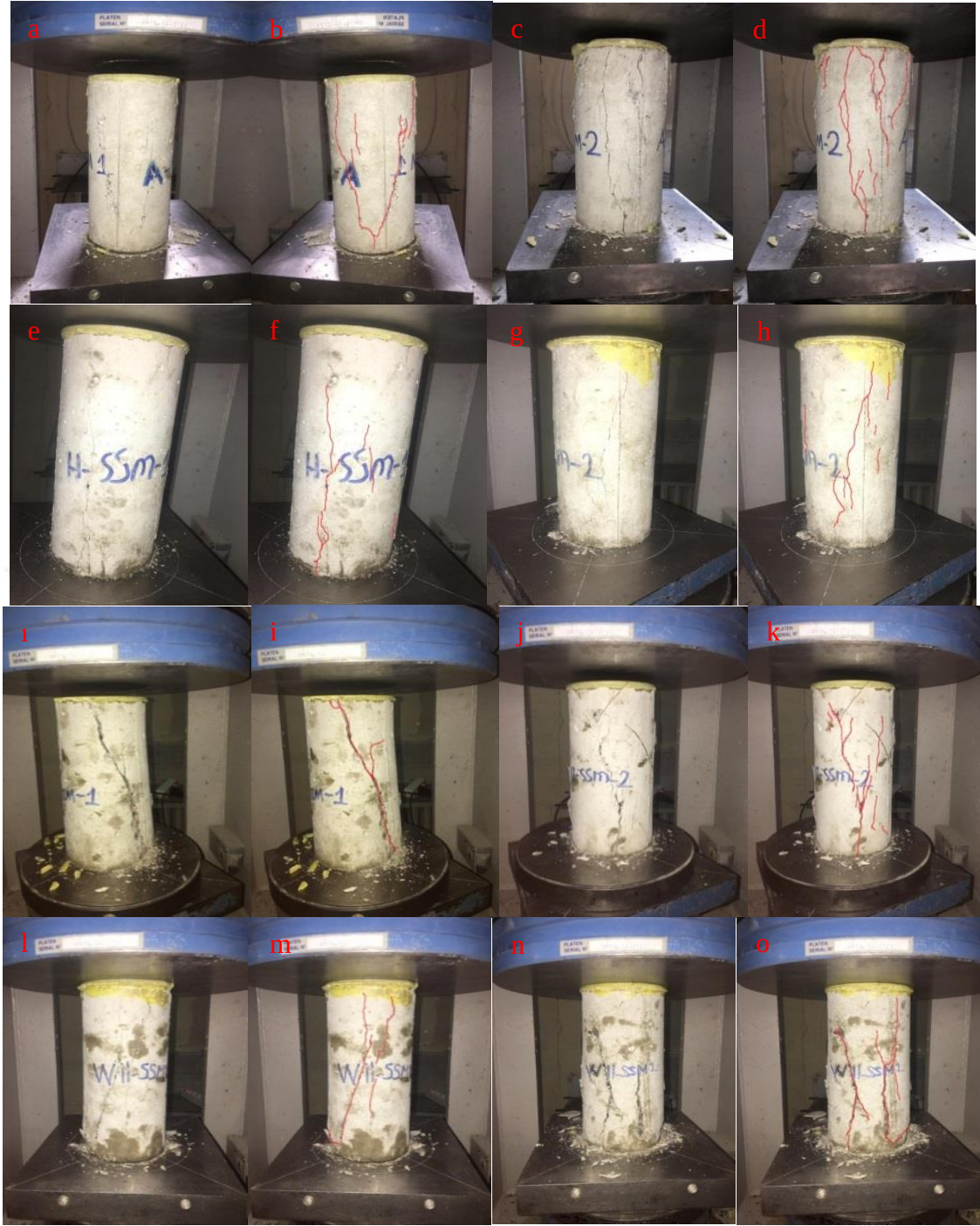
Şekil 74. A-SSM-1 (a ve b), A-SSM-2 (c ve d), H-SSM-1 (e ve f), H-SSM-2 (g ve h), WI-SSM-1 (ı ve i), WI-SSM-2 (j ve k), WII-SSM-1 (l ve m) ve WII-SSM-2 (n ve o) numunelerine ait kırılma şekilleri.
