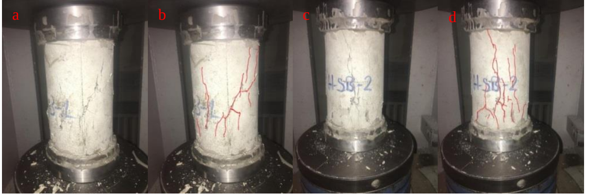
Şekil 50. H-SB-1 (a ve b) ve H-SB-2 (c ve d) numunelerine ait kırılma şekli.
