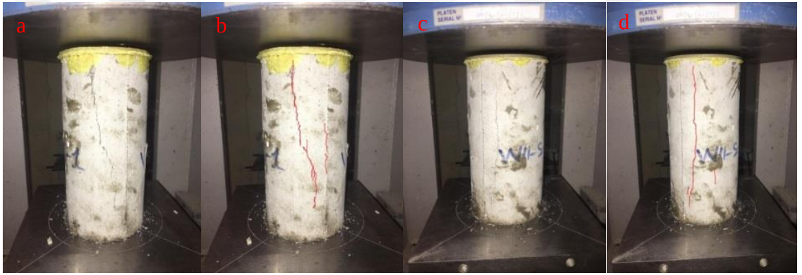
Şekil 65. WII-S-1 (a ve b) ve WII-S-2 (c ve d) numunelerine ait kırılma şekli.
