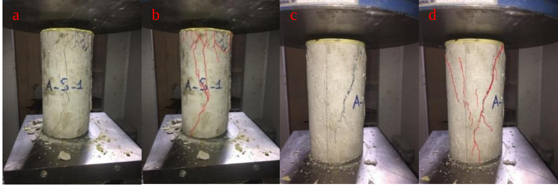
Şekil 44. A-S-1 (a ve b) ve A-S-2 (c ve d) numunelerine ait kırılma şekli.
