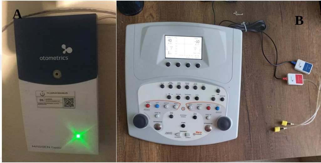
Şekil 3.1. Kontralateral supresyon testinde kullanılan cihazlar A. Madsen Capella2, B. Clinical Audiometer Inventis
