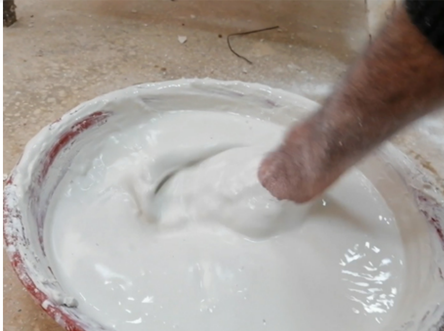
Görsel 26. Görsel 25’ den detay “At Başı Heykeli”, (Alçının iyi karışması için vibrasyon yapma yöntemi)
