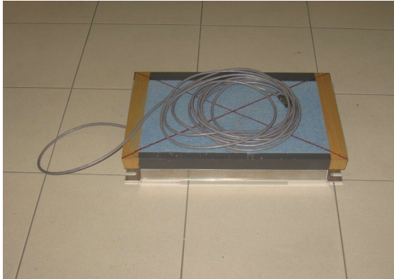
Resim 3.3. Kuvvet platformu (FP 4060-10, BERTEC, A.B.D.).
