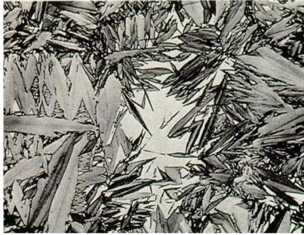
Şekil 5.12: Martenzitik Bir Alaşım Mikro Yapı Görüntüsü
