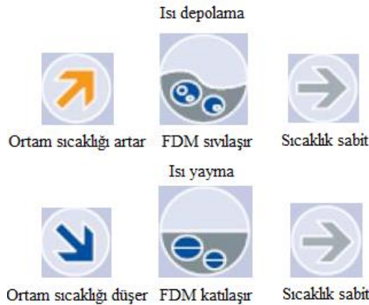
Şekil 1.4. FDM'lerin ısı depolama-yayma ve ısı düzenleme özelliklerini gösteren şematik gösterim (Karagönlü, 2011)
