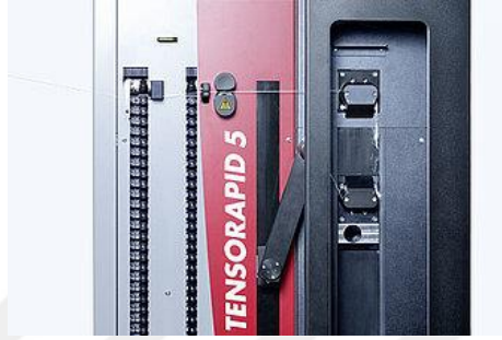
Şekil 3.11. Çalışmada kullanılan Uster Tensorapid 5 iplik mukavemet test cihazı
