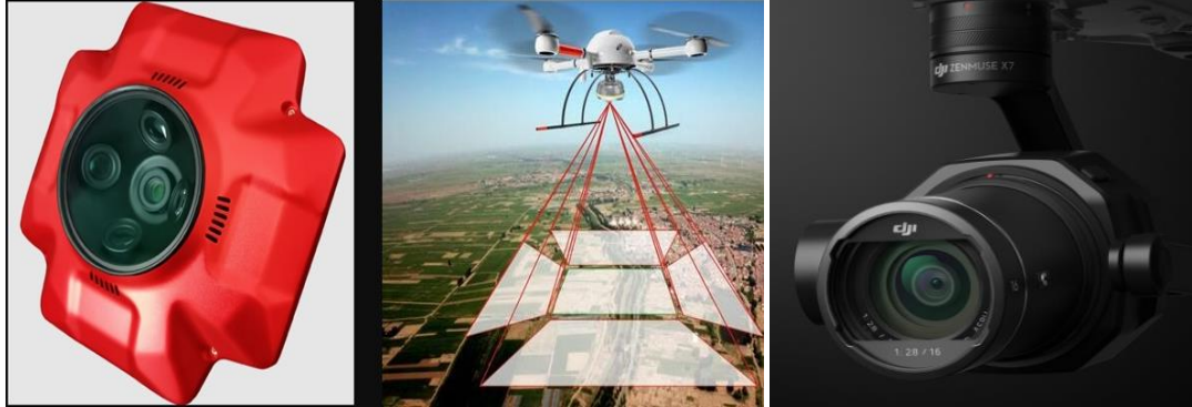
Resim 67: Oblik Kamera (Solda), Dikey ve Açılı Görüntü Alabilen Kamera (Sağda)
