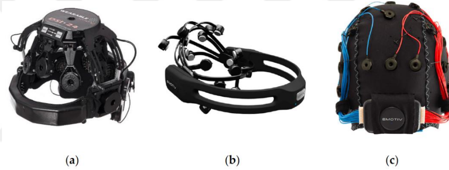
Şekil 7: EEG Cihazının Farklı Modellerine Örnekler – a: Kuru, b: Tuzlu Sulu, c: Jel Bazlı
