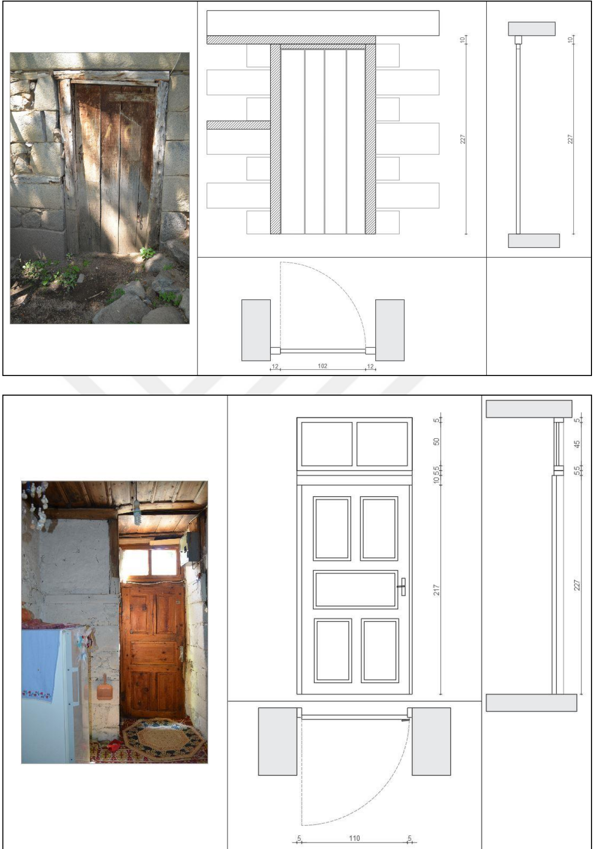
Şekil 110. Dış kapı tipleri.
