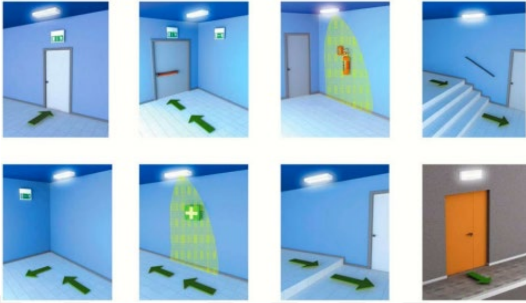
Şekil 4.4. EN 1838 standardına göre kaçış yolu aydınlatması.
