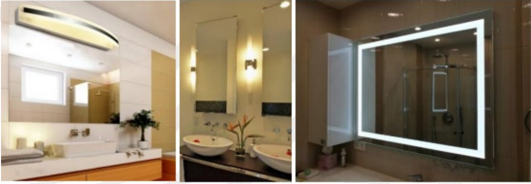
Şekil 2.20. Üstten, düşey iki yandan ve çevresel ayna önü aydınlatma örnekleri.
