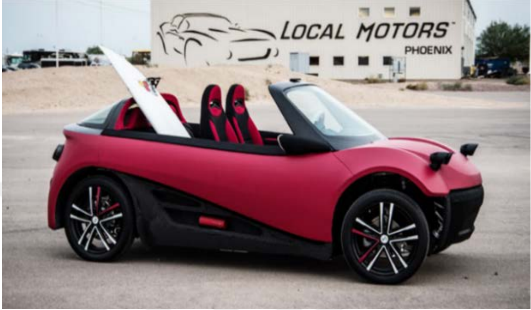
Şekil 3.4: Local Motors'un katmanlı imalatla üretmiş olduğu araba.
