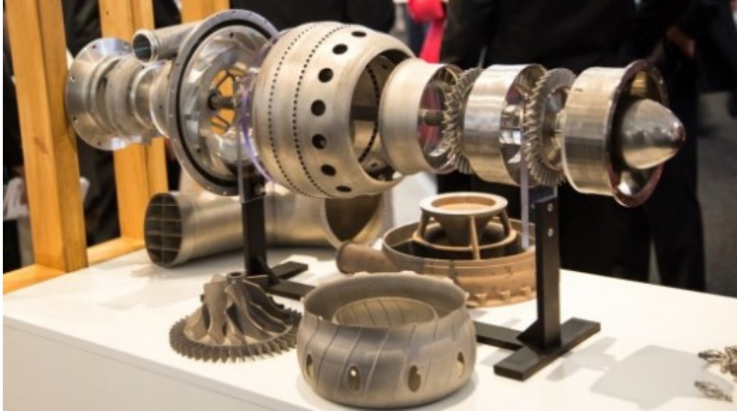
Şekil 3.2: 3 Boyutlu Yazıcı ile Yapılan İlk Jet Motoru
