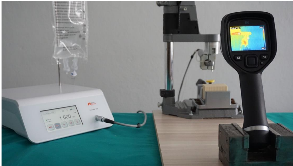
Şekil 3-11: Kızılötesi termal kamera ile deney düzeneği
