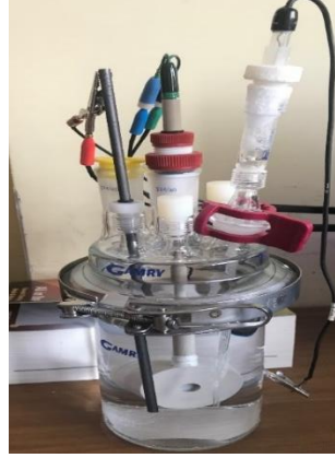
Şekil 6.2 : Gamry elektrokimyasal korozyon düzeneği/3 elektrot tekniği
