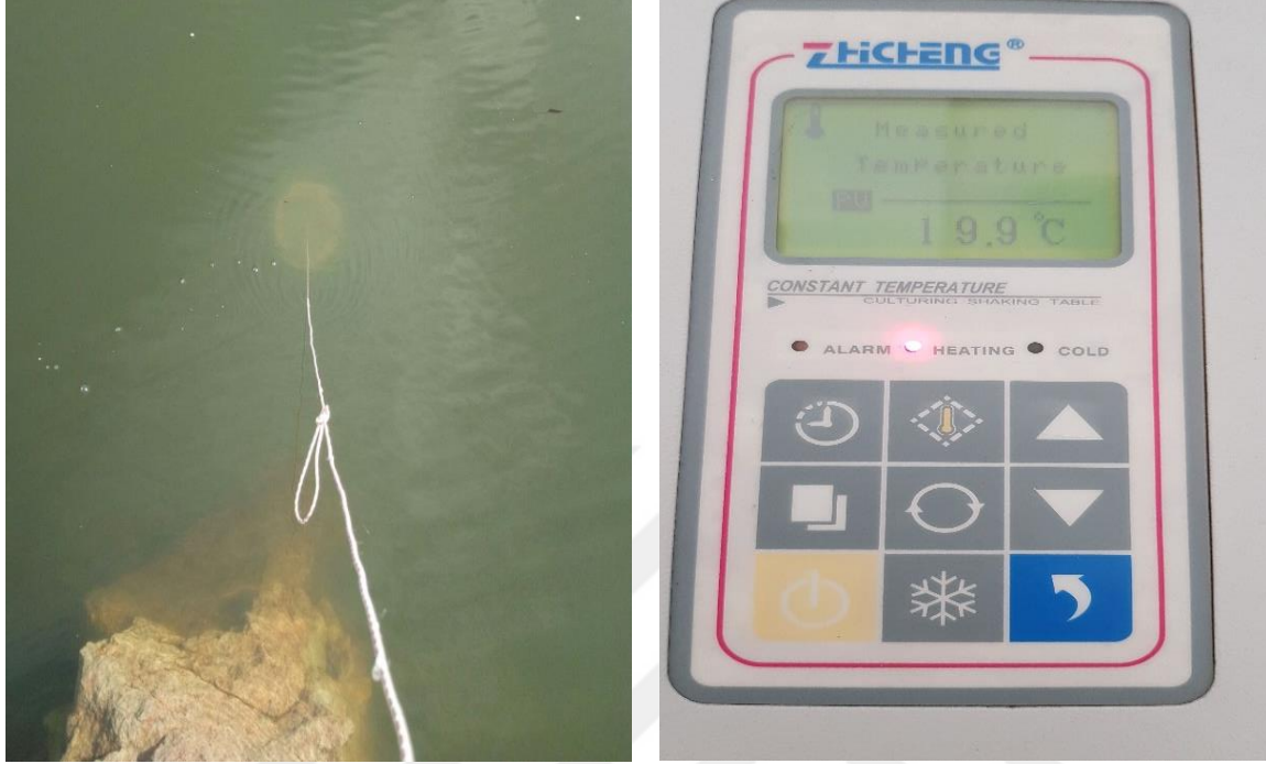
Şekil 5.3. Seki derinliği, sıcaklık gibi parametrelerin anlık ölçümü
