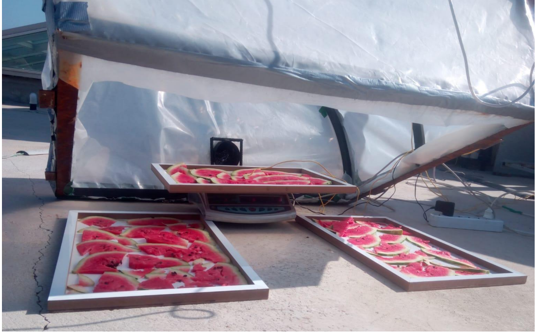
Şekil 3.3.: Solar enerji kabininde karpuzun pörsütülmesi
