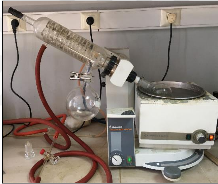
Şekil 6. Hekzanın uçurulduğu vakumlu evaporatör düzeneği.
