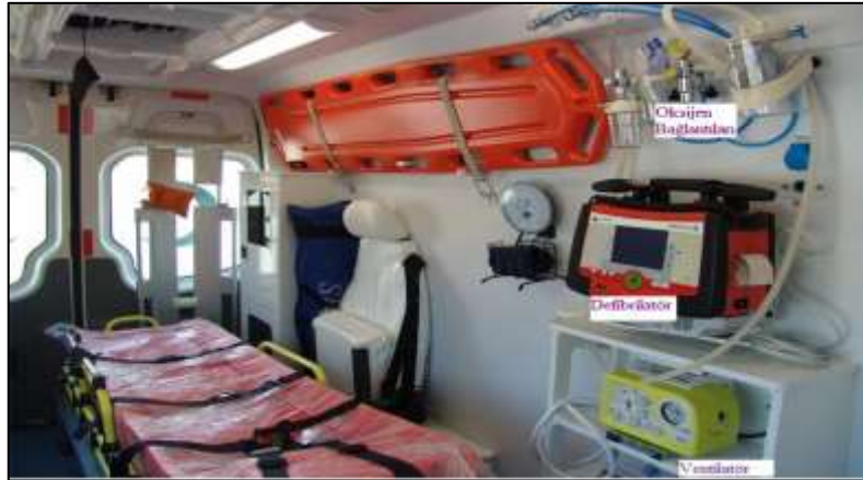
Şekil 3.7. Defibrilatör, Ventilator ve Oksijen Bağlantıları [31]
