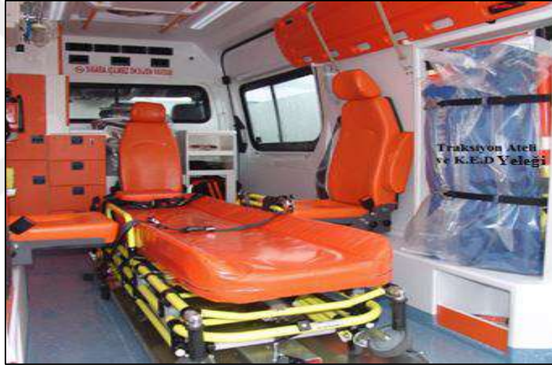
Şekil 3.6. Traksiyon Ateli ve K.E.D Yeleğinin Ambulanstaki Yerleşimi [31]
