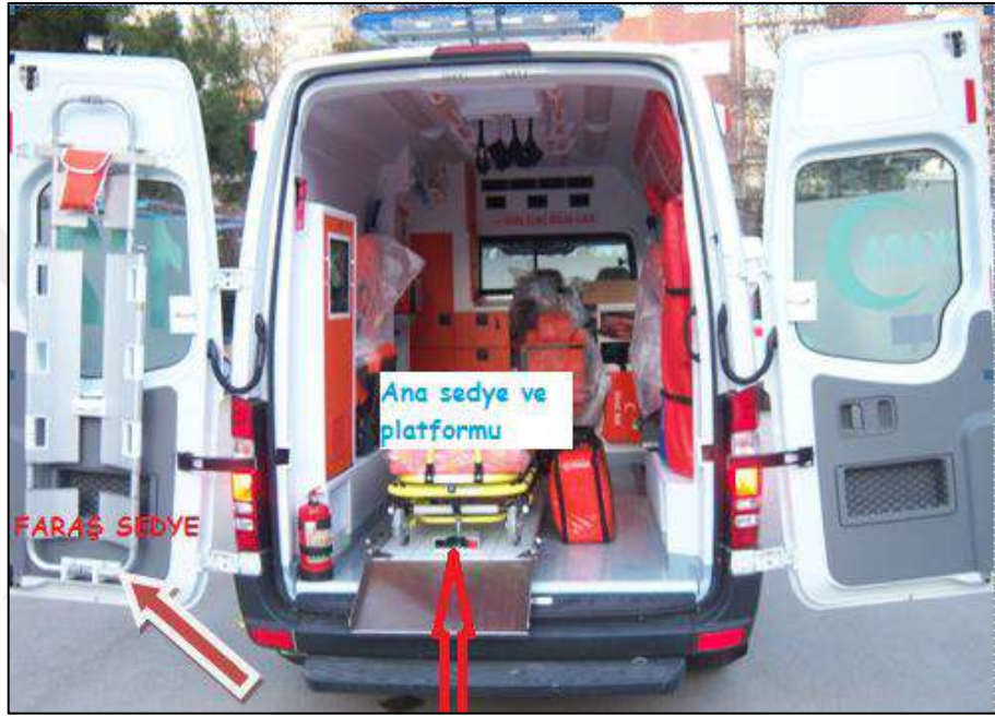
Şekil 3.3. Faraş Sedye ve Ana Sedyenin Ambulans İçindeki Yerleşimi [31]
