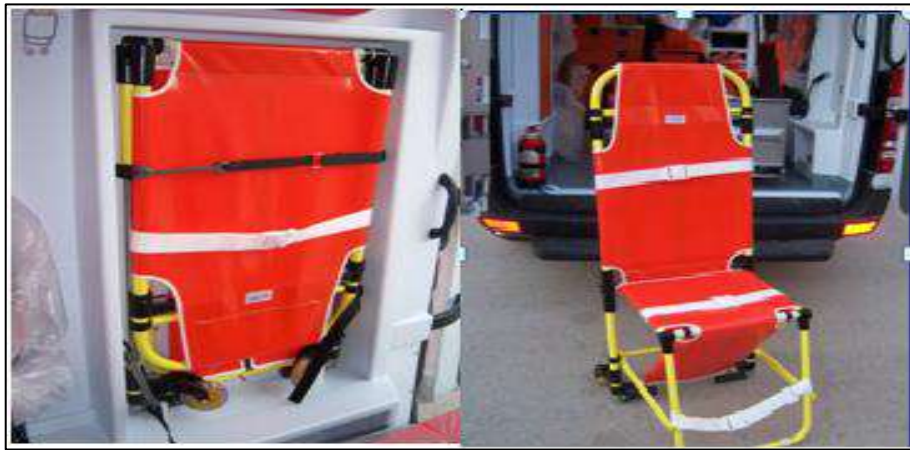
Şekil 3.4. Kombinasyon Sedyenin Ambulans İçerisindeki Yerleşimi [31]
