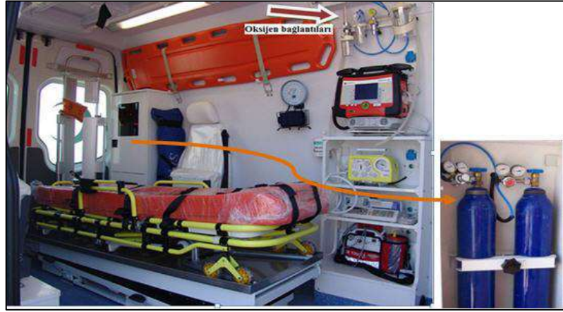
Şekil 3.8. Oksijen Tüpleri ve Bağlantıları [31]
