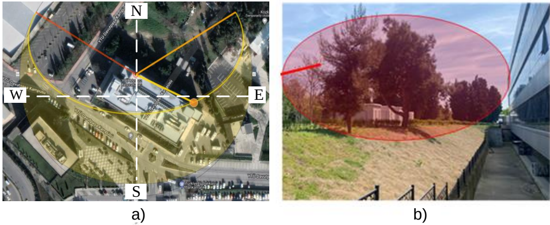
Şekil 3.21 Merkez laboratuvar binası üzerindeki güneş hareketi (a) ve direk güneş ışığını engelleyen ağaçlar (b).
