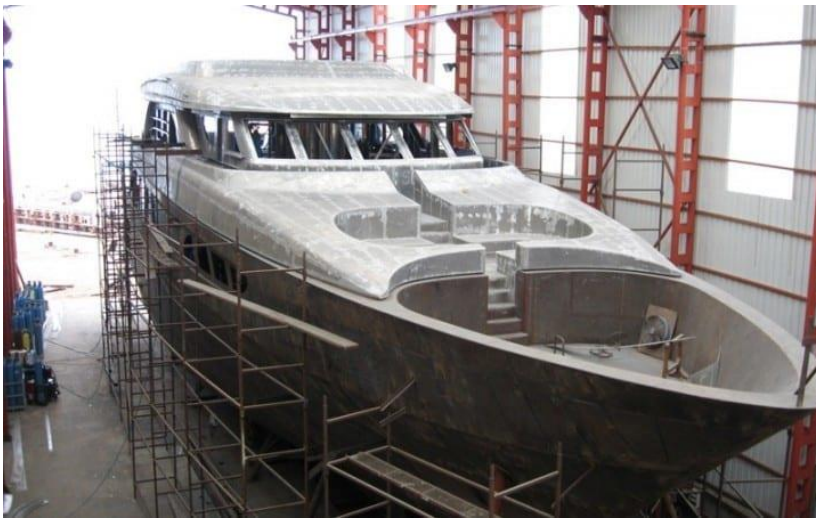
Şekil 1.5. Yat İmalatında Kompozit Malzeme (Kalender, 2018)
