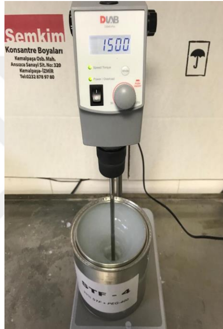
Şekil 3.6. STF çözeltisinin kap içerisinde mekanik karıştırıcı ile karıştırılması.
