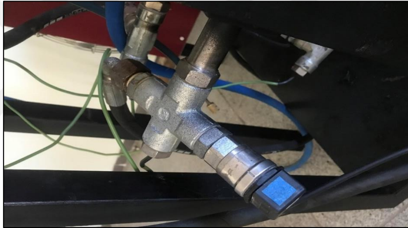
Şekil 3.18. Basınç sensörü ve bağlantısı
