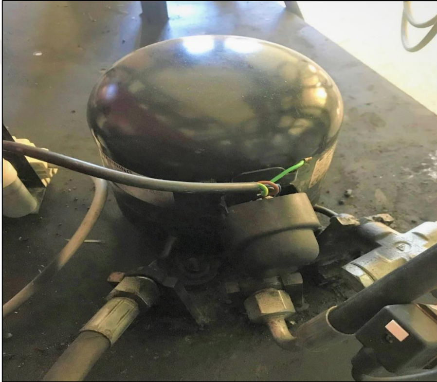
Şekil 3.4. Sistemde kullanılan hermetik kompresör
