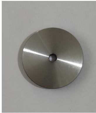
Şekil3.2: CNC tornalama işleminden sonra 316 L iş parçasının görüntüsü.
