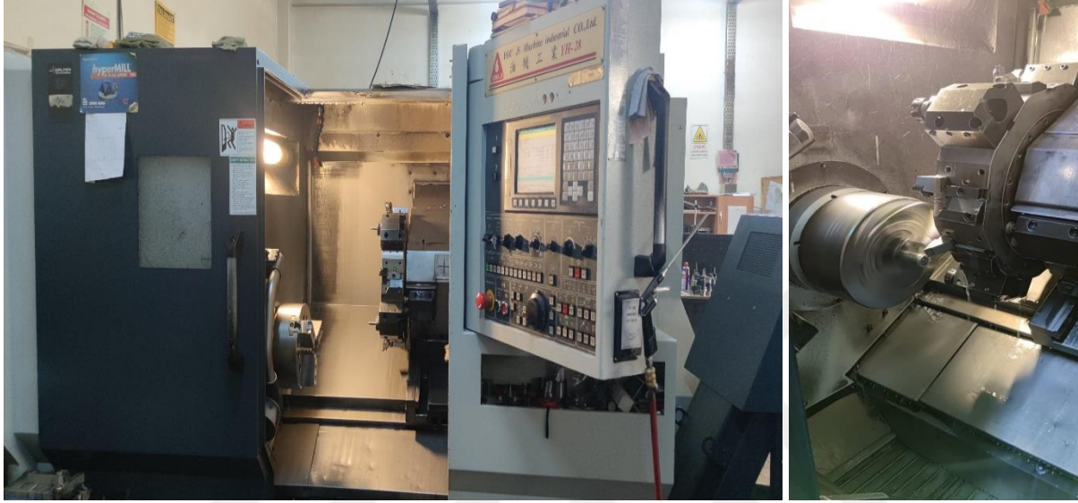
Şekil3.1: Deneysel çalışmada tornalama işlemleri için kullanılan CNC tezgâhı.
