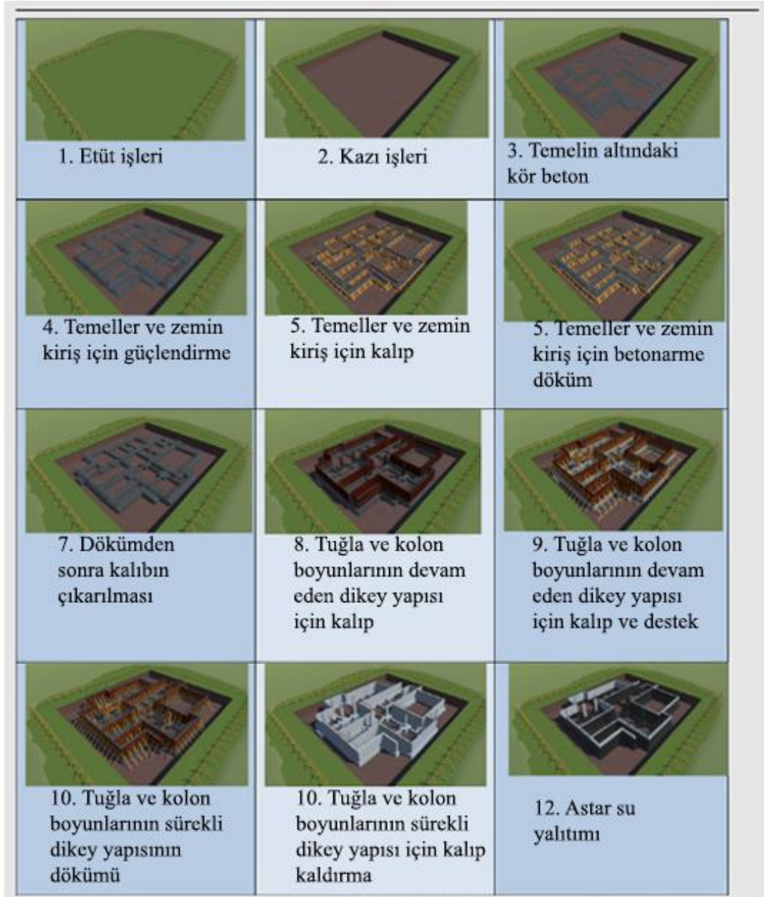
Şekil 2. 18 : Sanal Gerçeklikte sunulan inşaat işleri sürecinin bazı adımları (Bashabsheh ve diğ., 2019).
