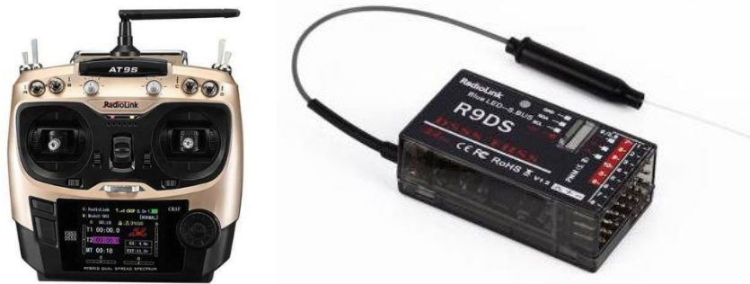
Şekil 17. AT9S RC vericinin (solda) ve R9DS RC alıcının (sağda) fotoğrafları.
