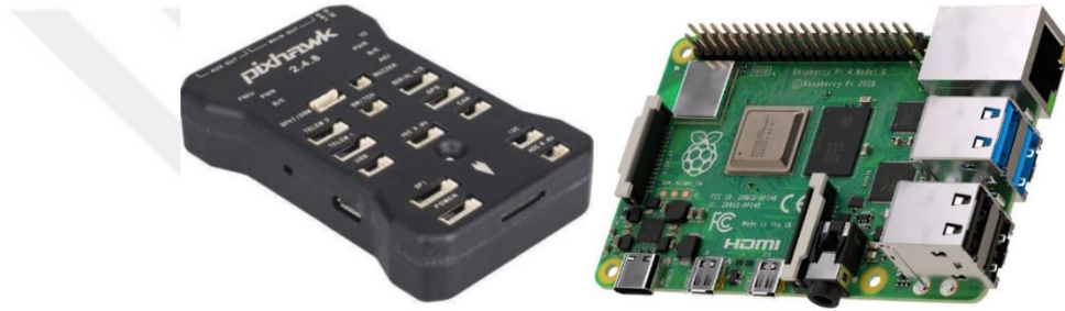
Şekil 9. Pixhawk 2.4.8 uçuş kontrol kartı (solda) ve Raspberry Pi 4 (sağda) fotoğrafları.
