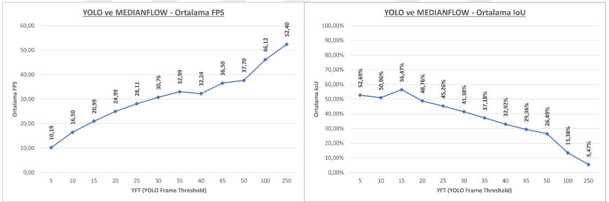
Şekil 47. MEDIANFLOW algoritmasının YOLO ile farklı YFT değerlerinde ürettiği FPS (solda) ve IoU (sağda) değerleri.
