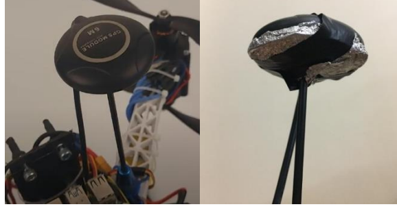
Şekil 10. İHA gövdesindeki GPS modülünün ve modül altındaki RF kalkanının fotoğrafları.
