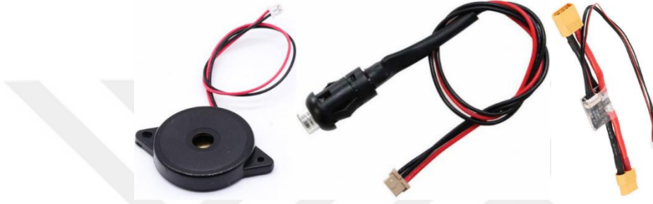
Şekil 12. Gövdede kullanılan buzzer (solda), safety switch (ortada) ve güç modülünün (sağda) fotoğrafları.
