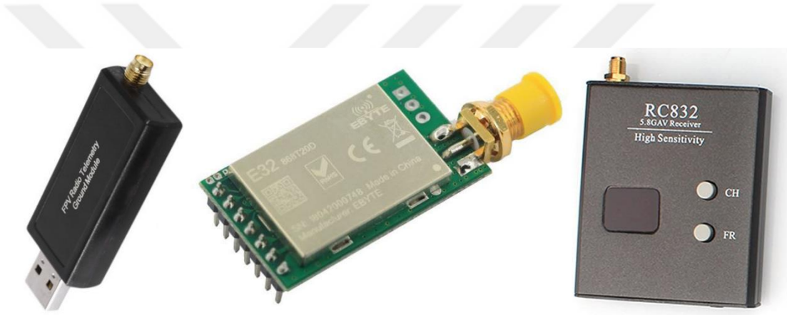
Şekil 28. Telemetri (solda), LoRa (ortada) ve RC832 video alıcısı (sağda) fotoğrafları.
