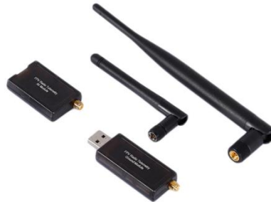
Şekil 13. Telemetri alıcı ve vericisinin antenleriyle birlikte fotoğrafı.
