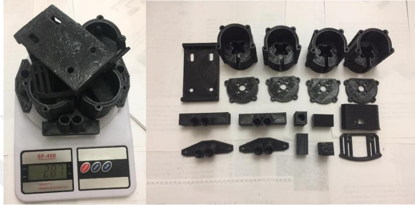
Şekil 38. 3B çıktılarının ağırlıklarının ölçülmesi (solda) ve üretilmiş parçalar (sağda).
