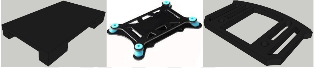
Şekil 5. İHA gövdesindeki montaj alanının artırılması için kullanılan levhalar. Solda gövde alt katında kullanılan levha, ortada gövde üst katında işlem birimi için kullanılan levha ve sağda kamera modülünün üstünde kullanılan ızgara gösterilmiştir.
