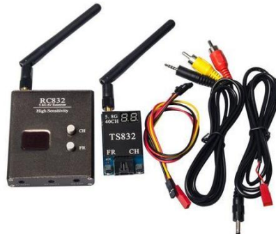
Şekil 15. FPV alıcı ve vericisinin bađlantı kablolarıyla birlikte fotođrafi.
