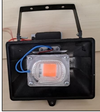
Şekil 3.38. LED bitki yetiştirme lambasının projekte montajı
