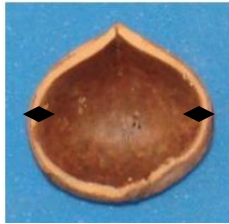
Şekil 3.5. Kabuk kalınlığının ölçüleceği kısım
