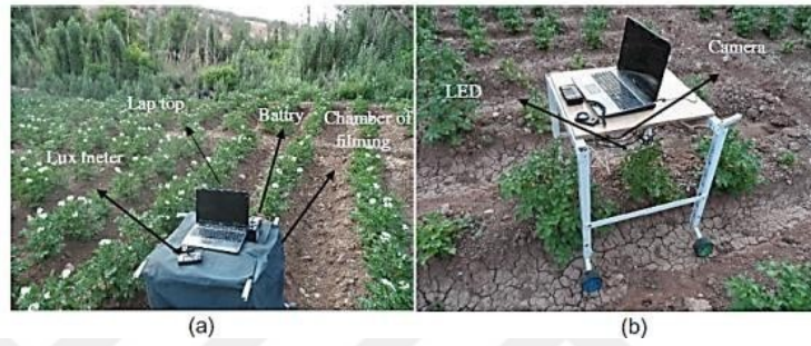
Şekil 2.6. Çekim Sistemi a) Kontrollü Mod b) Kontrolsüz Mod (Sabzi ve Abbaspour-Gilandeh, 2018).
