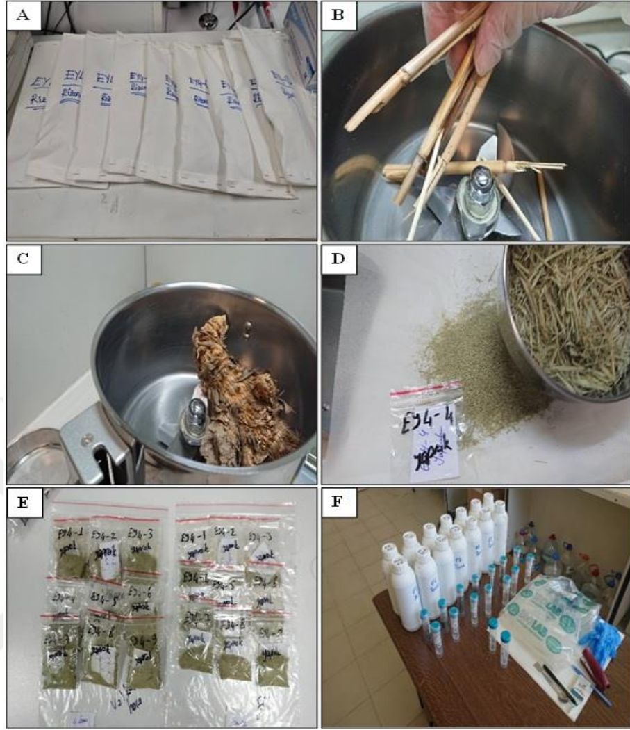
Şekil 3.3. Çalışma kapsamında örneklenen A. donax , P. australis , su ve sediment örneklerinin analize hazırlanması.
