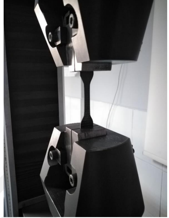
Resim 6.2. Çekme deneyi numunesi (a) ve çekme deneyi yapılışı (b)
