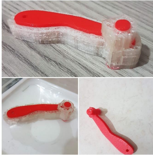
Şekil 1. PVA filamentinin suda çözünmesi
