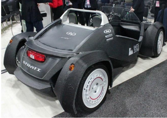
Görsel 2.14: Üç Boyutlu Yazıcı Vasıtasıyla Üretilmiş Olan İlk Araba "Strati"
