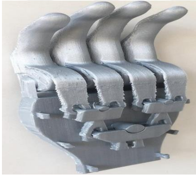
Görsel 2.12: Üç Boyutlu Yazıcı Vasıtasıyla Üretilmiş Olan Protez El
