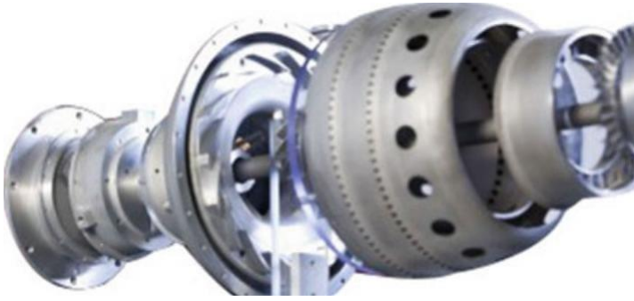
Görsel 2.16: Üç Boyutlu Yazıcı Vasıtasıyla Üretilmiş Olan Jet Motoru Prototipi
