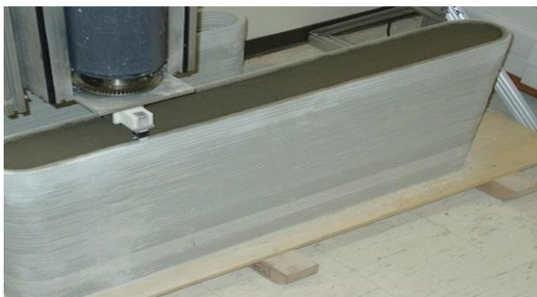
Görsel 2.17: Üç Boyutlu Yazıcı Vasıtasıyla Üretilmiş Olan Duvar Prototipi
