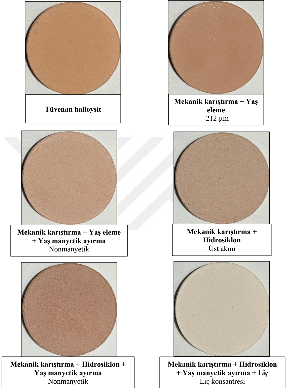
Şekil 4.94: Tüvenan ve cevher hazırlama/zenginleştirme işlemleri uygulanmış halloysit cevherinin duvar karosu hammadde pişmeleri.
