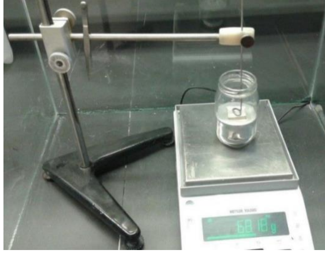
Şekil 3.16: Görünür yoğunluk ölçüm düzeneği.
