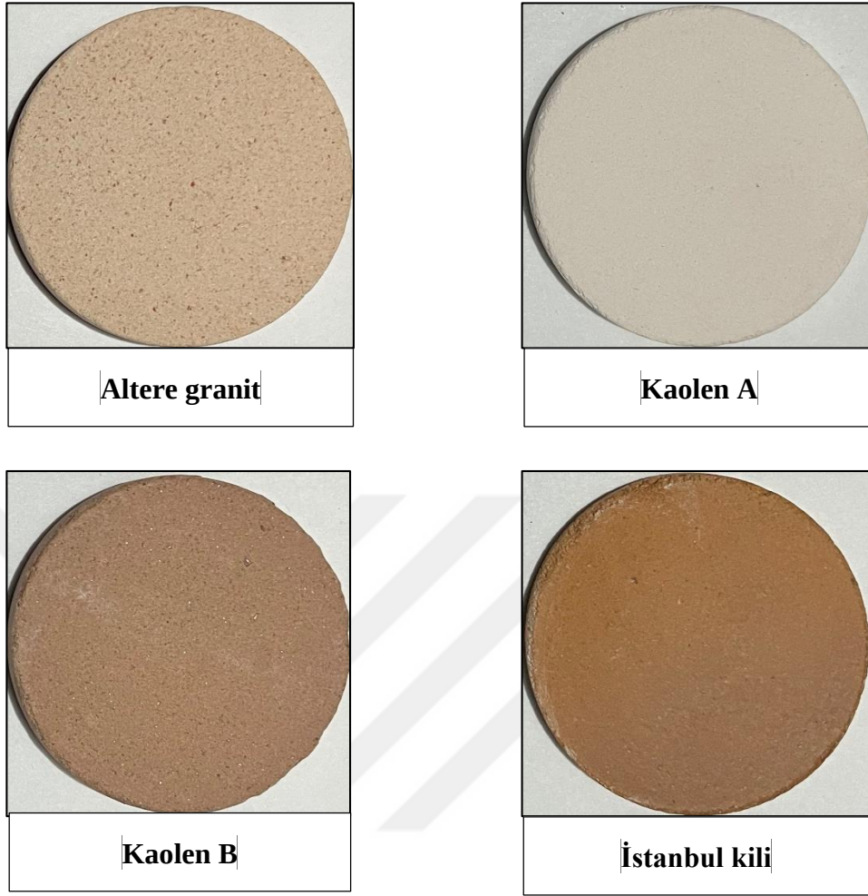
Şekil 4.98: Duvar karosu reçete geliştirme çalışmalarında kullanılan hammaddelerin duvar karosu şartlarında sinterlenmiş tablet görüntüleri
