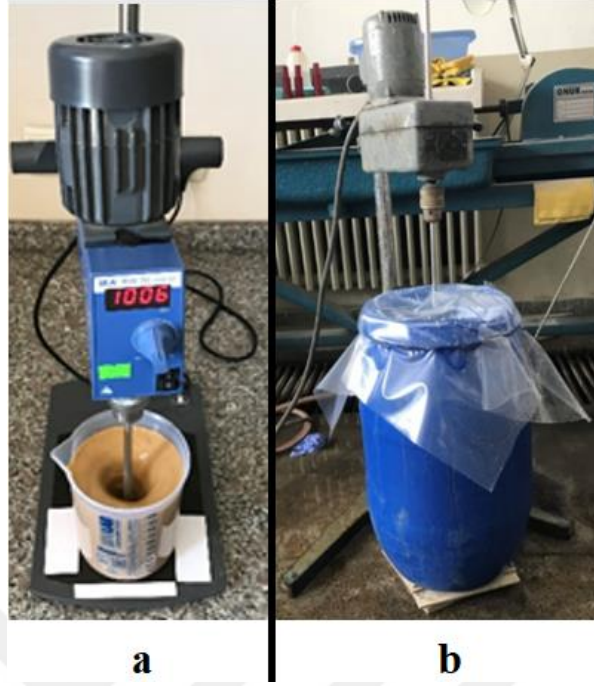
Şekil 3.9: a) Laboratuvar ölçekli bıçaklı mekanik karıştırıcı, b) Pilot ölçekli bıçaklı karıştırıcı.
