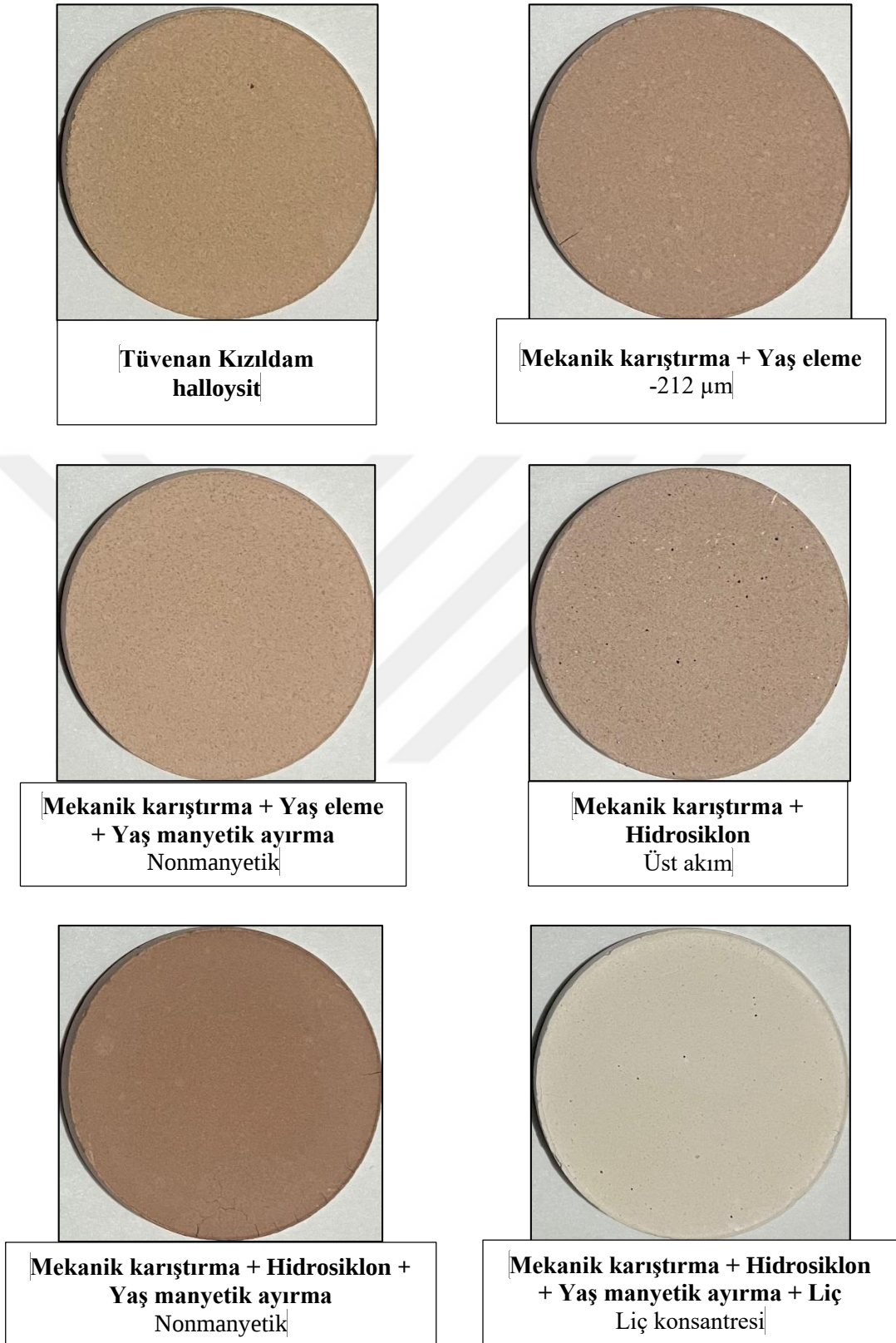
Şekil 4.97: Tüvenan ve cevher hazırlama/zenginleştirme işlemleri uygulanmış Kızıldam halloysit granit hammadde pişmeleri.
