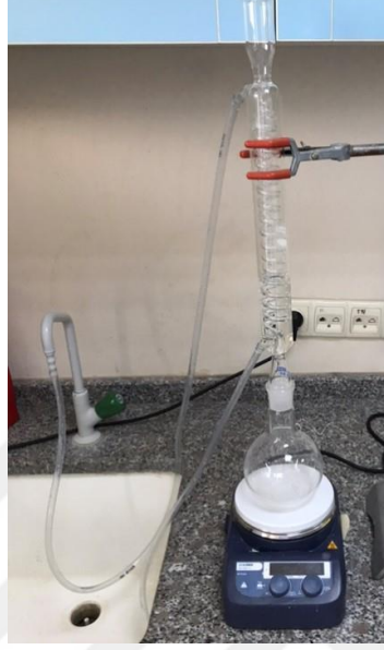
Şekil 3.15: Liç deneylerinde kullanılan deney düzeneği.
