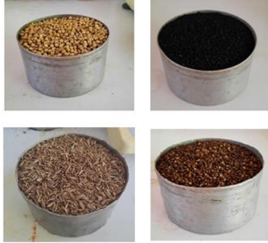
Şekil 3.11 Tohumların yığın hacim ağırlığı ölçümünde kullanılan silindirik örnek kapları
