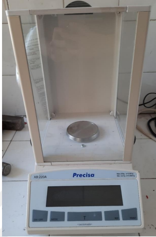
Şekil 3.9 Bin dane ağırlığı (g/1000 dane) ölçümünde kullanılan hassas terazi
