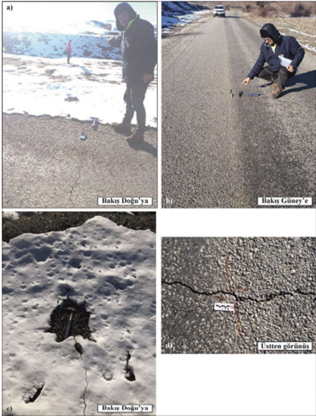
Şekil 4.26. Sivrice İlçesinin hemen 2 km batısında, yaklaşık K-G doğrultu yönünde kalan Yedikardeş Köyü'ne giden asfalt yolu üzerinde gelişen yüzey-kırık deformasyon yapıları (Kürçer ve diğ., 2020).
